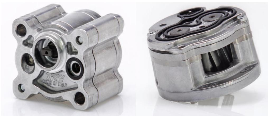
Il cuore della pompa è composto da due ingranaggi di acciaio speciale. Il processo produttivo di questi componenti prevede la dentatura, il trattamento termico e tre fasi di rettifica e supfinitura.
