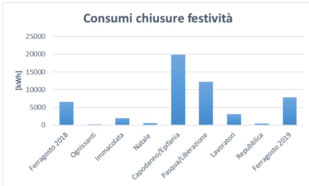
Come ipotizzabile, il bilancio delle perdite si aggrava aggiungendo il contributo di tutti i compressori della sala A: si arriva, in meno di 14 mesi, ad un totale di 90000 kWh e quasi 12000 € spesi durante i periodi di chiusura totali. I dettagli delle perdite sono riportati nel grafico che segue.
