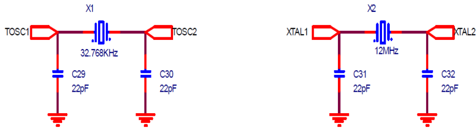
Figura 3.17: Schema elettrico dei due cristalli: a sinistra quello da 32.768 kHz (per il real timer counter ); a destra quello da 12 MHz (per il clock di sistema).
