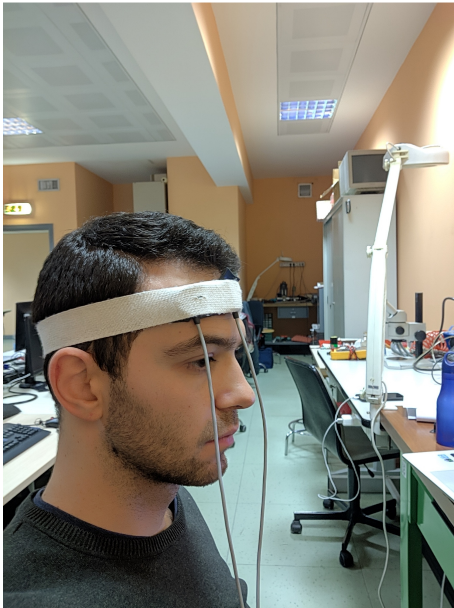
Figura 6.4: Tipico posizionamento della sonda sul soggetto: sonda emittente sulla tempia, rilevatore sulla fronte.
