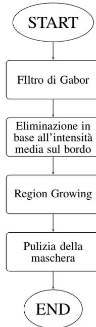
Figura 2.22: Pipeline per la segmentazione del lume.
