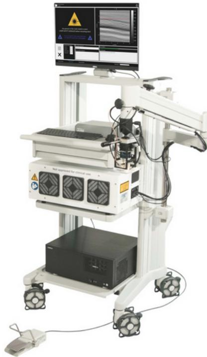
Figura 3.6: Dispositivo *RSOM Explorer C50*, essendo un dispositivo clinico è provvisto di un carrellino per il trasporto e di un pedale di sicurezza visibile in basso [28].
