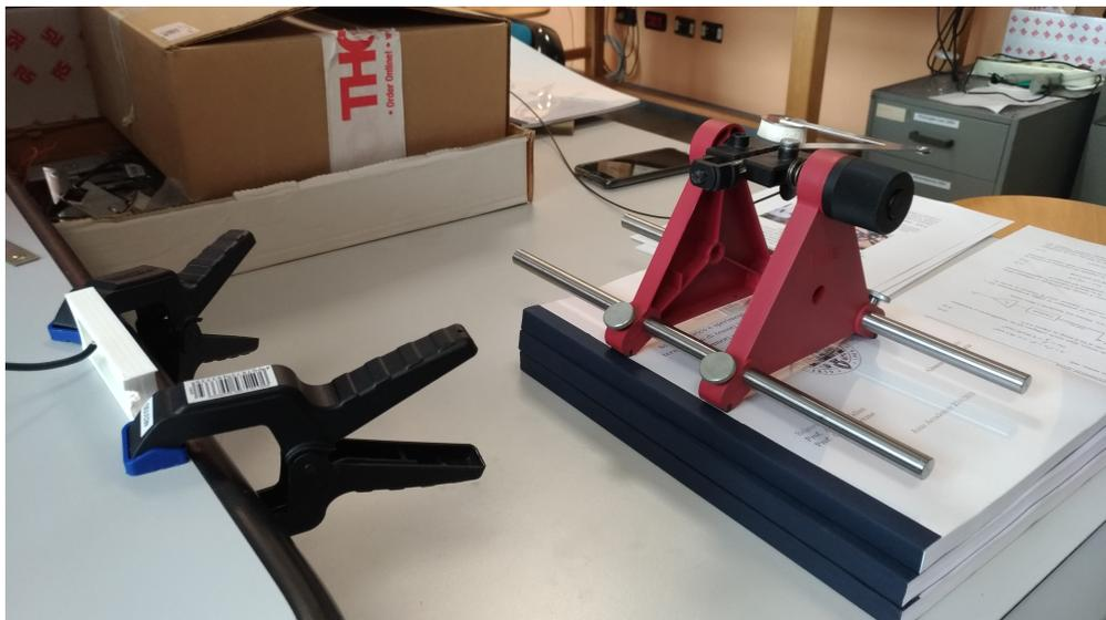
Figura 5.11: *Setup* e disposizioni spaziale degli elementi per misurazioni radiometriche.
