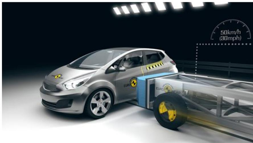
*Figura 2.3: Test di impatto laterale EuroNCAP (18)*
