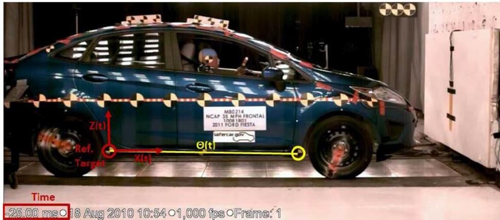
*Figura 4.31: Esempio diagramma dati di inclinazione raccolti mediante analisi video di una prova (34)*
