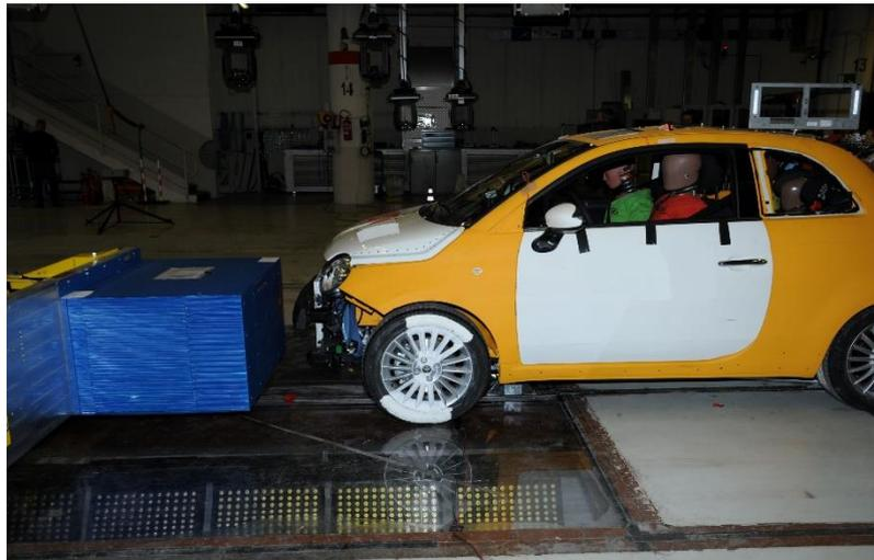
*Figura 4.1: Esempio dinamica urto MPDB Full Scale*
