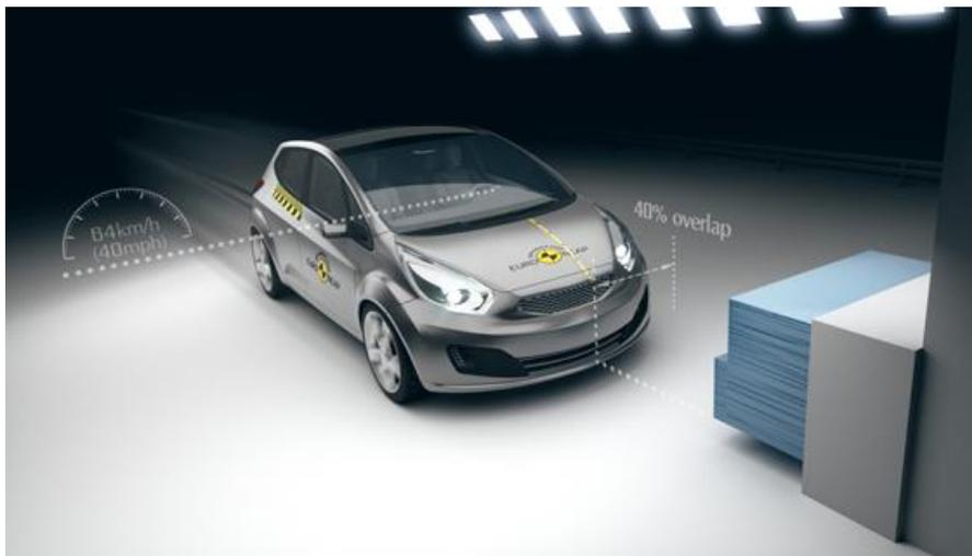
*Figura 2.1: Test frontale disassato EuroNCAP (16)*
