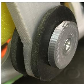
Figura 10.5: Giunto con due distanziali di 3 mm
