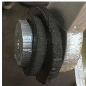
Figura 10.13: Giunto con ispessimento del perno e con due distanziali di 3 mm
