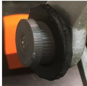
Figura 10.11: Giunto con ispessimento del perno e con distanziale di 3 mm
