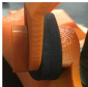
Figura 8.16: Giunto con due distanziali di 3 mm
