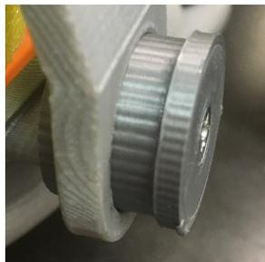
Figura 10.9: Giunto con ispessimento del perno
