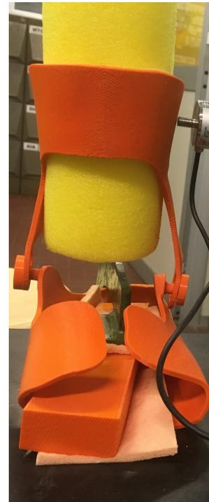
Figura 8.67 Ortesi con il dummy leg e il dummy foot inseriti
