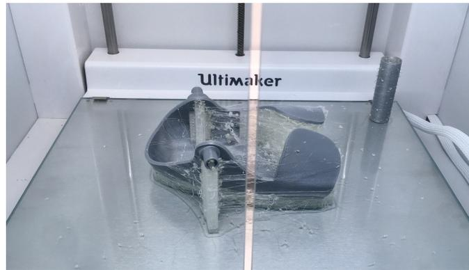
*Figura 9.12: Scafo del piede subito dopo la stampa prima della rimozione del PVA*
