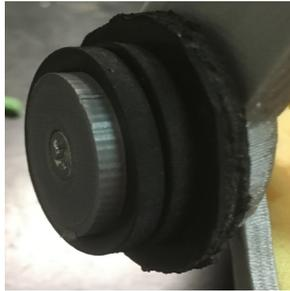
Figura 10.15: Giunto con ispessimento del perno e con tre distanziali di 3 mm
