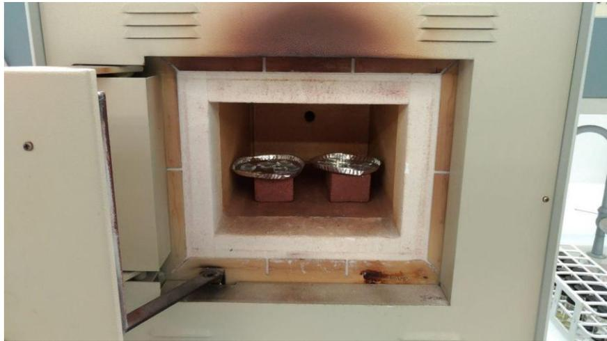
**Figura 4.2** Fotoanodi posti in muffola per il trattamento termico
