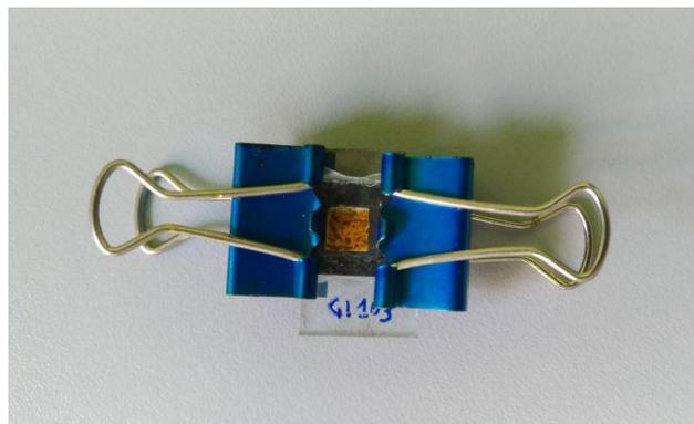
**Figura 4.7** Cella chiusa utilizzando delle pinze.
