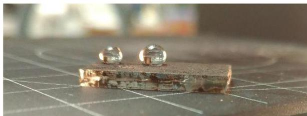
**Figura 5. 20** Gocce d'acqua depositate sulla superficie dell'elettrodo.
