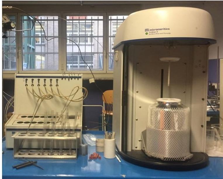
**Figura 2.3:** strumento per la porosimetria ad azoto.
