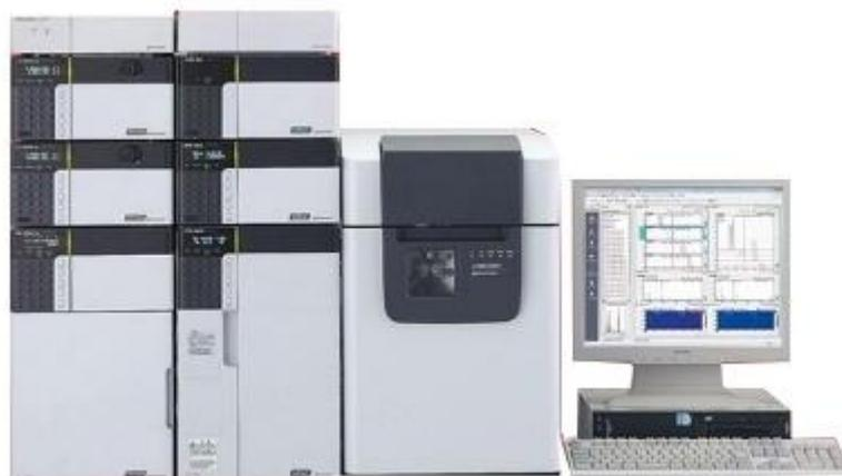
Figura 2.11: HPLC della Shimadzu Prominence.
