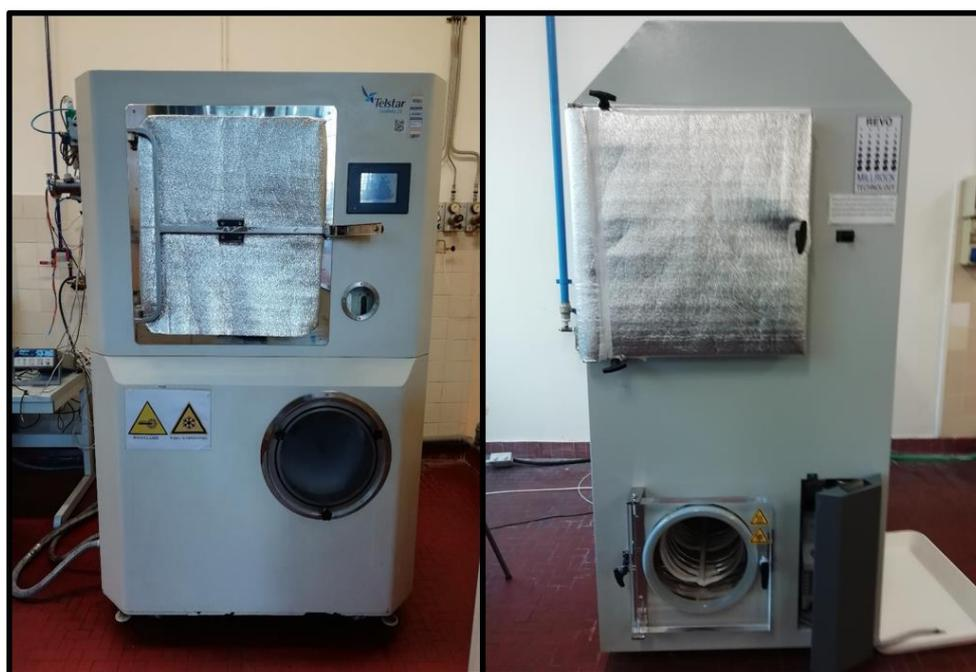
*Figura 3.5 -Liofilizzatori utilizzati per le prove sperimentali. A sinistra il Telstar LyoBeta 25, a destra il REVO® Freeze Dryer.*
