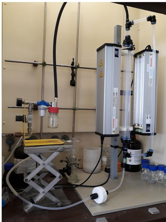
**Figura 1:** L'intera strumentazione utilizzata con atomizzatore, reattore e filtro per la raccolta del prodotto.
