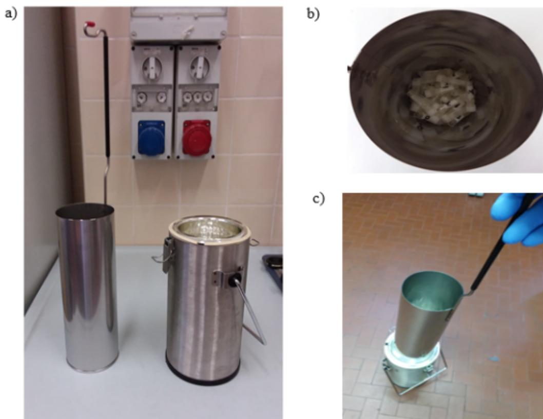
**Figura 2.7** a) Da sinistra a destra rispettivamente: contenitore per il carico dei flaconi e contenitore azoto liquido. b) Vista dall'alto del contenitore per il carico dei flaconi. c) Immagine della prova d'immersione dei flaconi in azoto liquido.
