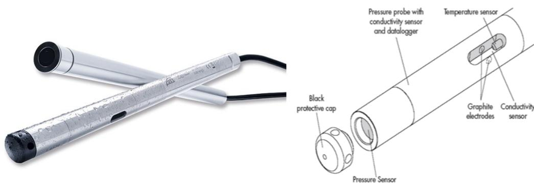
Figura 6.4. Immagine della Sonda OTT-CTD a sinistra e schema a destra.
