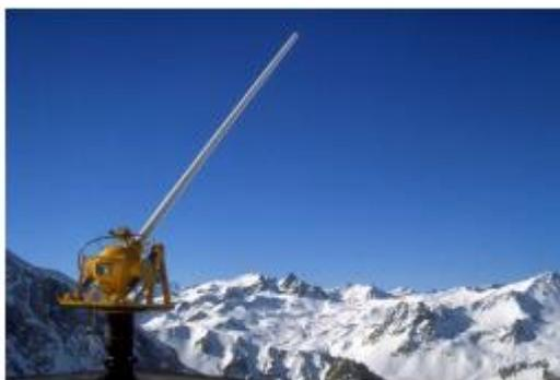
**Figura 2.1-Avalncheur posizionato su piattaforma girevole**
