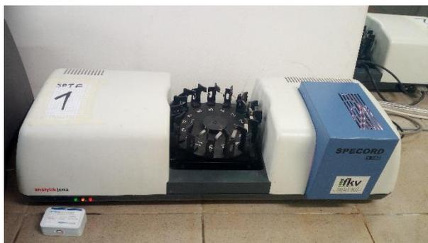
Figura 4.4 – Spettrofotometro a carosello, Specord S600
