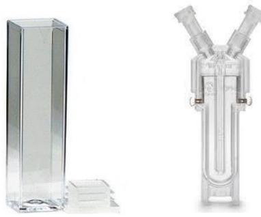
*Figura 4.8 – A sinistra: cuvetta per misurazione delle dimensioni, a destra: cella con elettrodi per misurazione del potenziale  $\zeta$*
