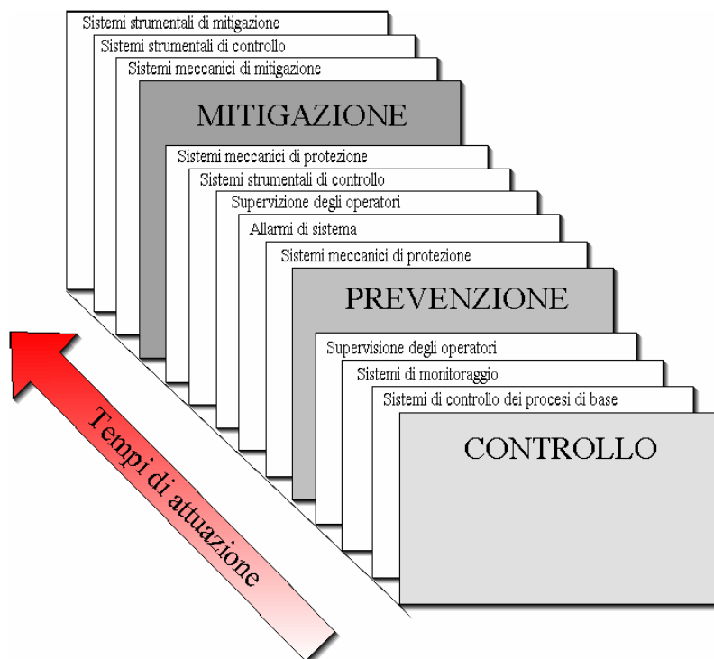
Figura 5 Principi di progettazione proposti dalle linee guida (ANAS, 2006)
