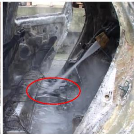
Fire acces, unico punto di accesso, se presente, dove poter "riempire" la batteria di acqua
