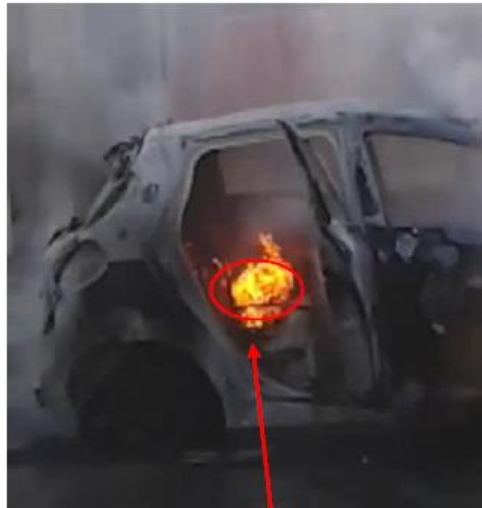
Pacco batterie con coperchio termofusibile (Fire-access).
