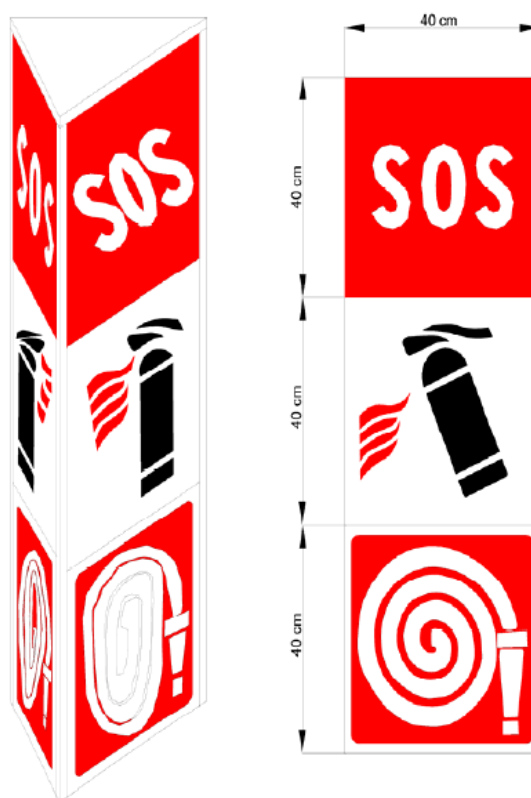
Figura 32 segnale di postazione idrante UNI 7546/8
