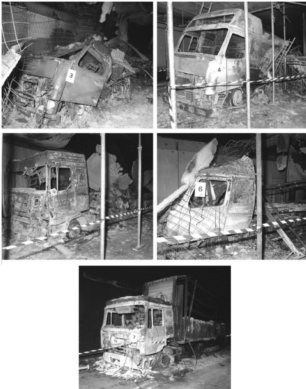
Figura 45 Autocarri dal 3 al 7 coinvolti nell'incendio. I suddetti veicoli erano in coda dietro l'autocarro italiano coinvolto nell'incidente iniziale
