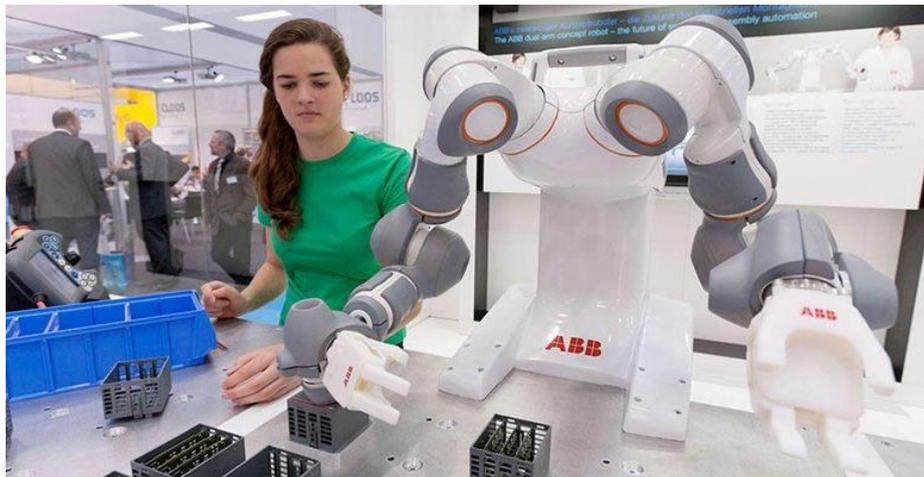
*Figura 6: Esempio di Cobot (Fonte: Feder Progetti)*
