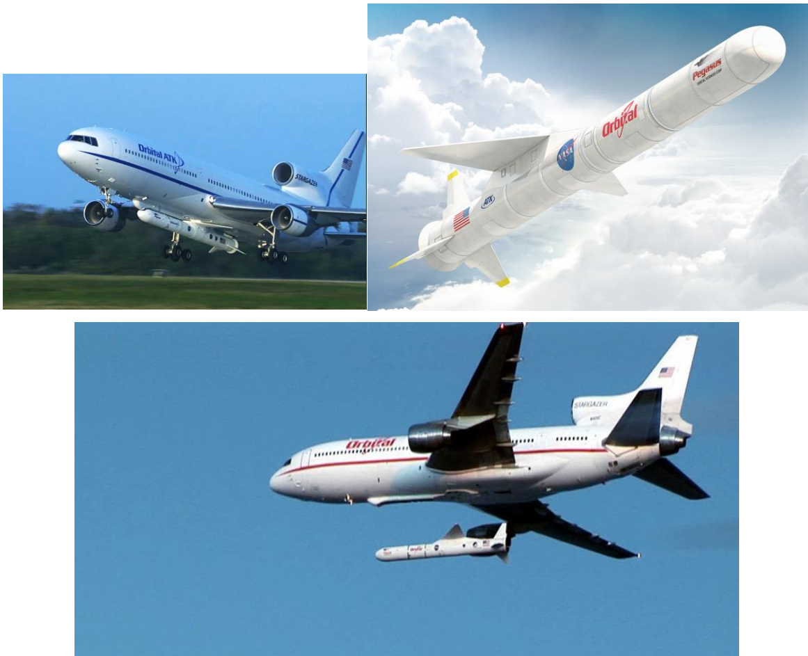
Figura 8 - Pegasus dell'Orbital ATK
