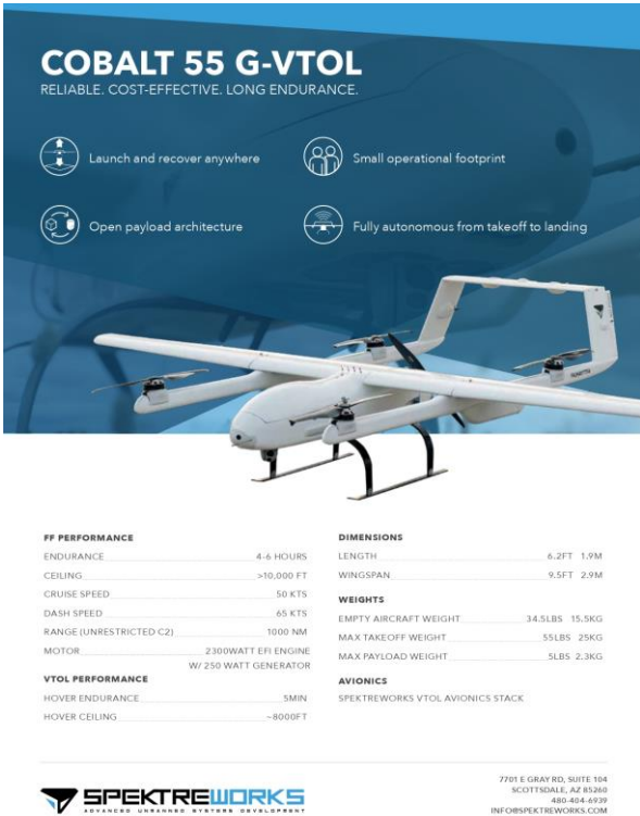
Figura 4.1 – Scheda tecnica Cobalt 55 G-VTOL
