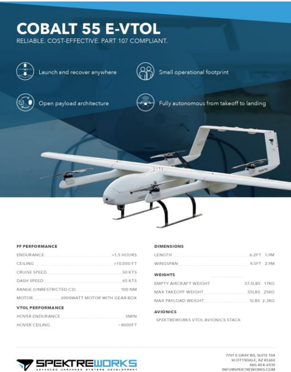
Figura 4.2– Scheda tecnica Cobalt 55 E-VTOL
