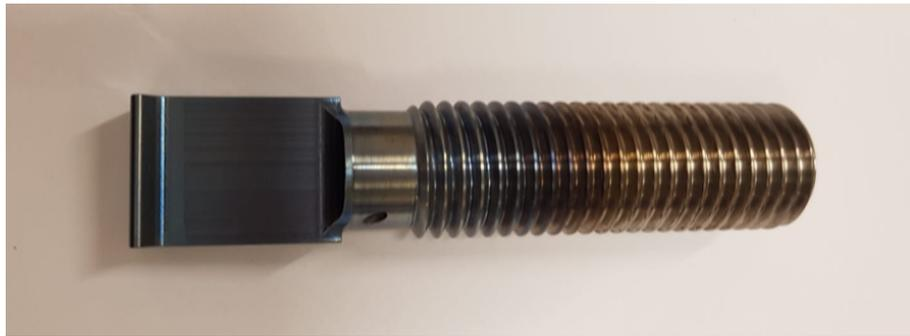
Figura 3.14. È mostrato il provino di taratura della temperatura dopo il riscaldamento: sulla sinistra è possibile osservare una colorazione bluastra dovuta all'ossidazione (avvenuta ad alta temperatura) della superficie del provino stesso mentre sulla destra il provino mostra un colore metallico.
