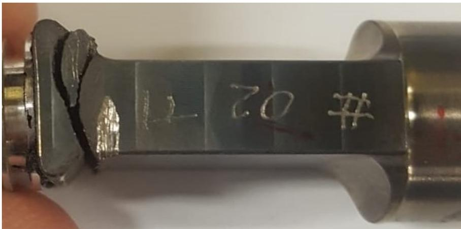
Figura 4.12. Provino sottoposto a 16kN dopo la rottura.
