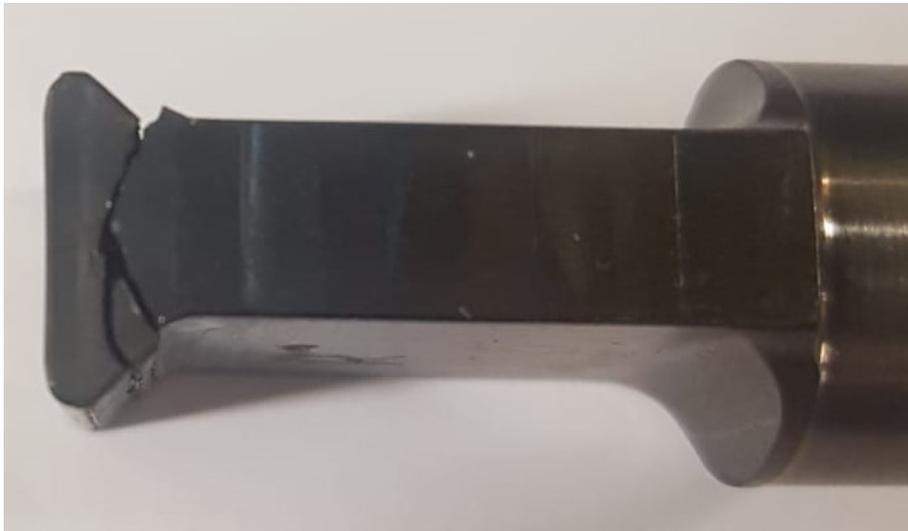
Figura 4.10. Provino sottoposto a 20kN dopo la rottura.
