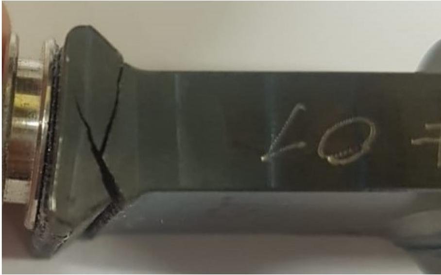
Figura 4.11. Provino sottoposto a 18kN dopo la rottura.
