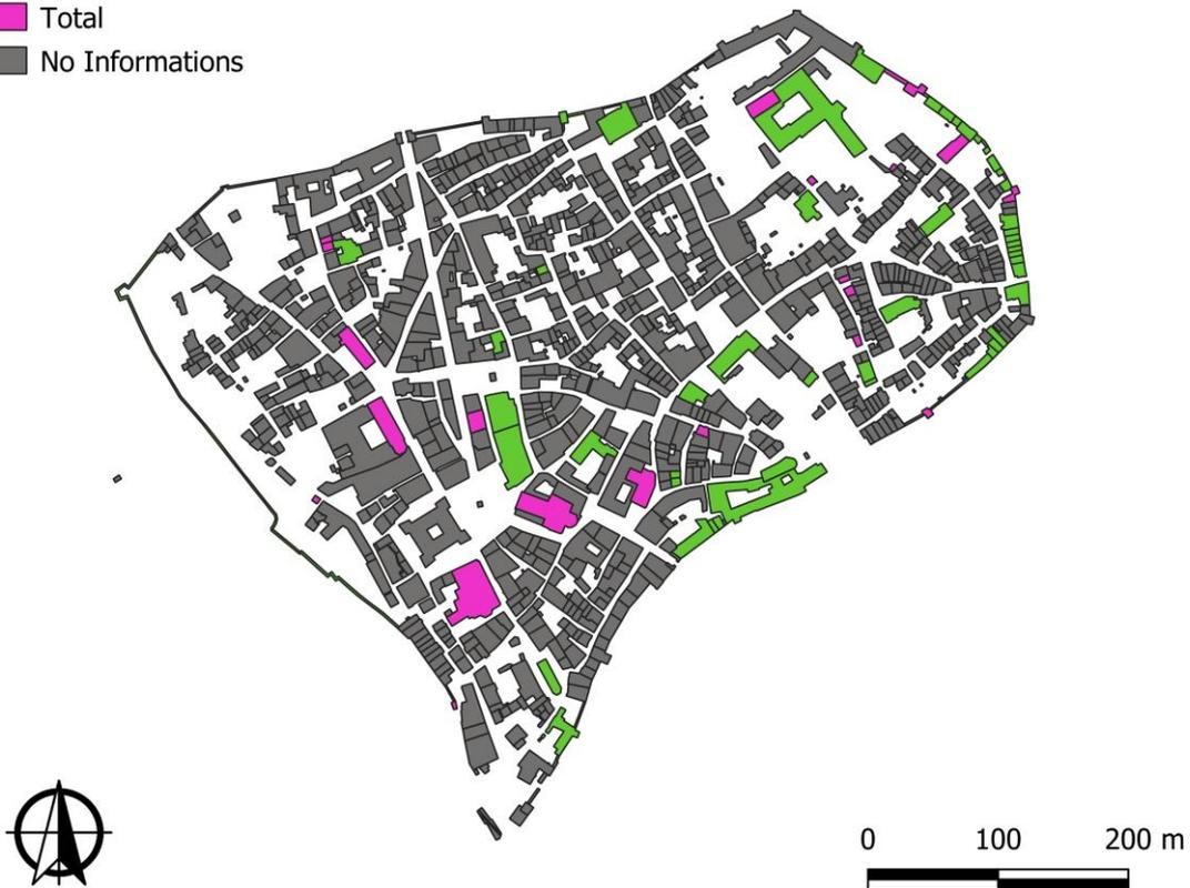
Figura 4-5 Edifici collassati parzialmente o totalmente del centro storico di Norcia (R. Sisti, M. Di Ludovico, et al. 2018)
