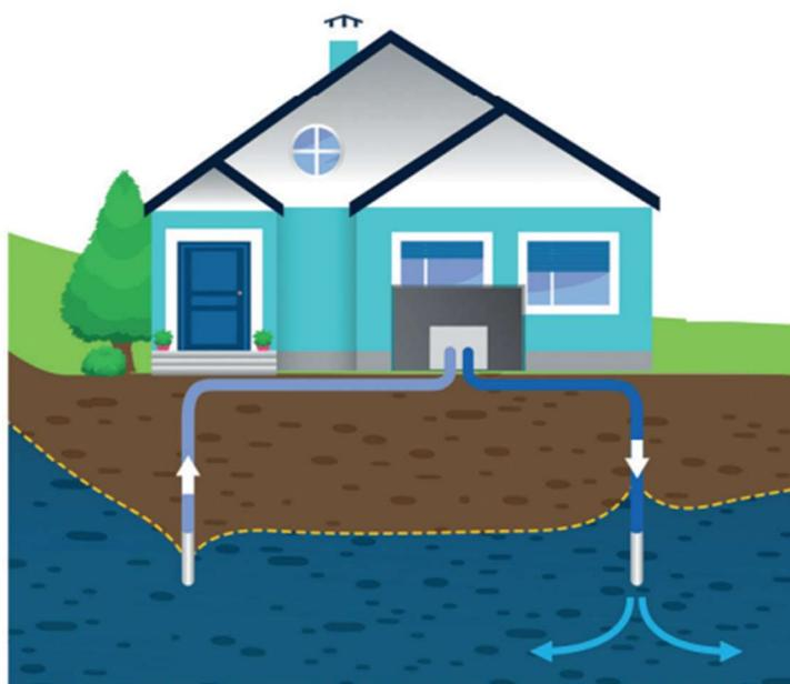
Figura 6 – Sistema geotermico aperto con pozzo di estrazione e di iniezione (BRGM)
