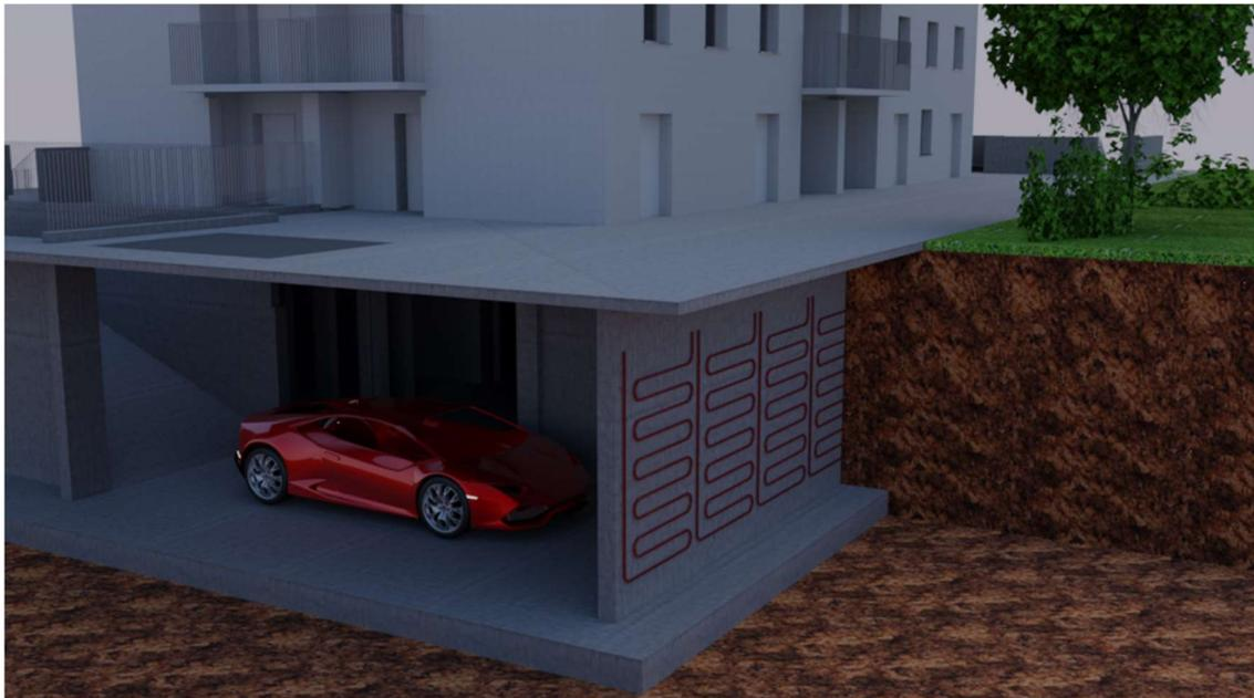
*Figura 65 – Posizionamento delle serpentine lungo il muro di sostegno di un edificio*
