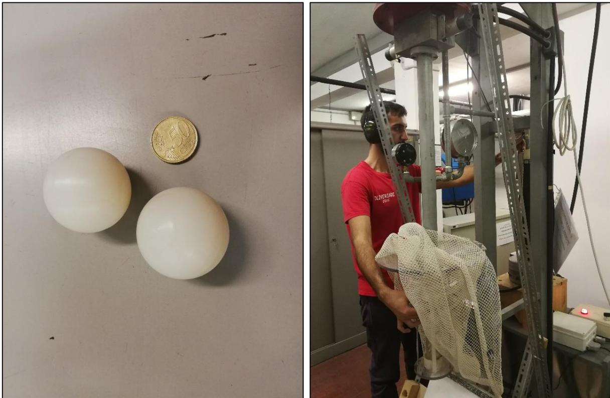
Figura 52. Inserimento delle sfere di poliammide all'imbocco della canna di sparo
