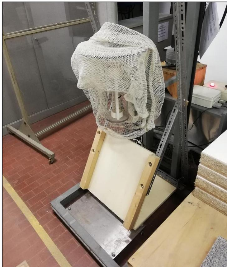
Figura 48. Posizionamento del supporto inclinato di  $60^\circ$  sotto la canna di sparo
