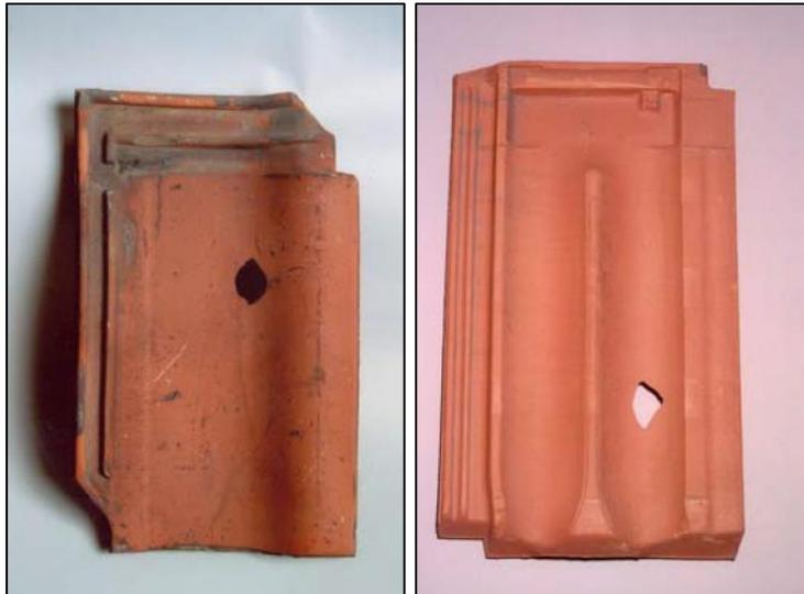
Figura 45. Confronto del danno su tegole laterizie. A destra danno causato da grandine reale e a sinistra quello provocato col metodo previsto dalla UNI 10890. Fonte: Nelva R., *L'effetto della grandine su cupole e lucernari. Sperimentazioni e Norme*, Zenital, Monza, 2008
