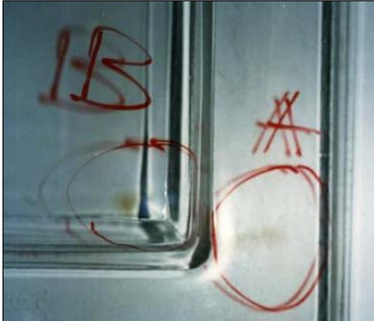
Figura 47. Esempio dell'effetto della prova su cupola in metacrilato antiurto: impatto denunciato dalla macchia opaca nel materiale. Fonte: *Nelva R., L'effetto della grandine su cupole e lucernari. Sperimentazioni e Norme, Zenital, Monza, 2008*
