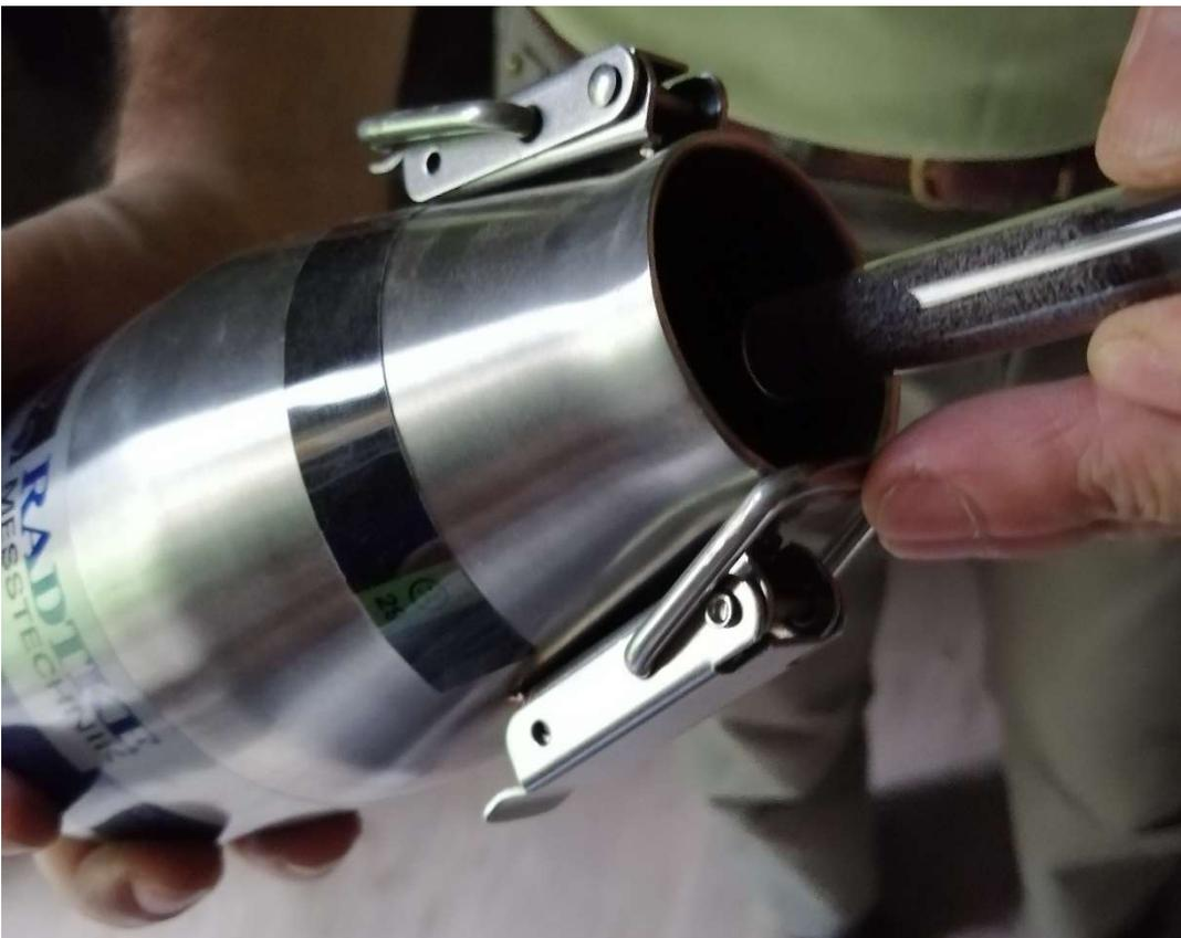
Fig. 40 - Inserimento della fialetta di carburo di calcio all'interno della bombola a pressione
