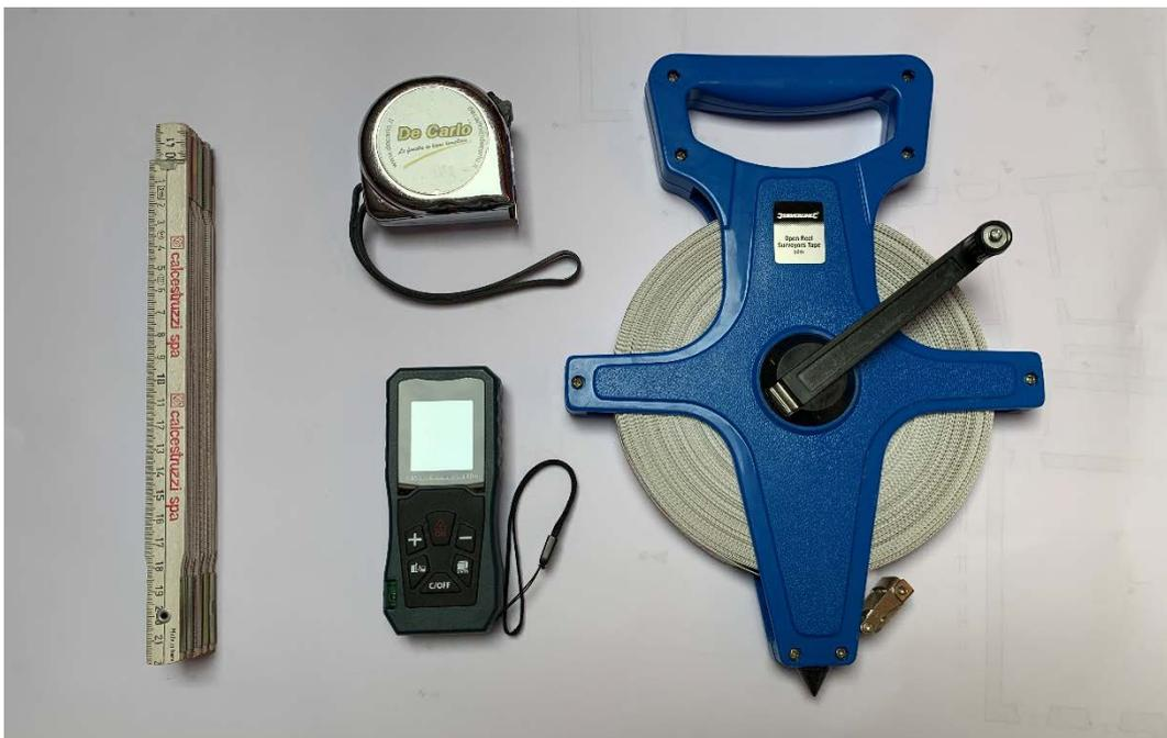
Figura 21. Strumentazione utilizzata per il rilievo diretto.
