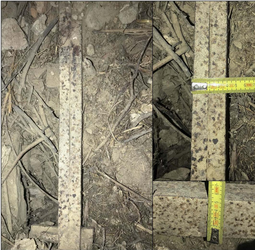
*Figura 110. Catena metallica con indicazioni della larghezza e dell'altezza.*
