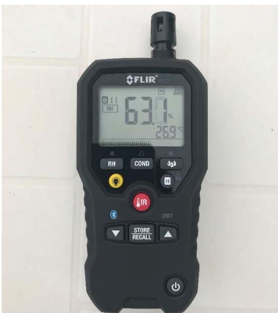
Figura 92. Misuratore di umidità FLIR MR 77.
