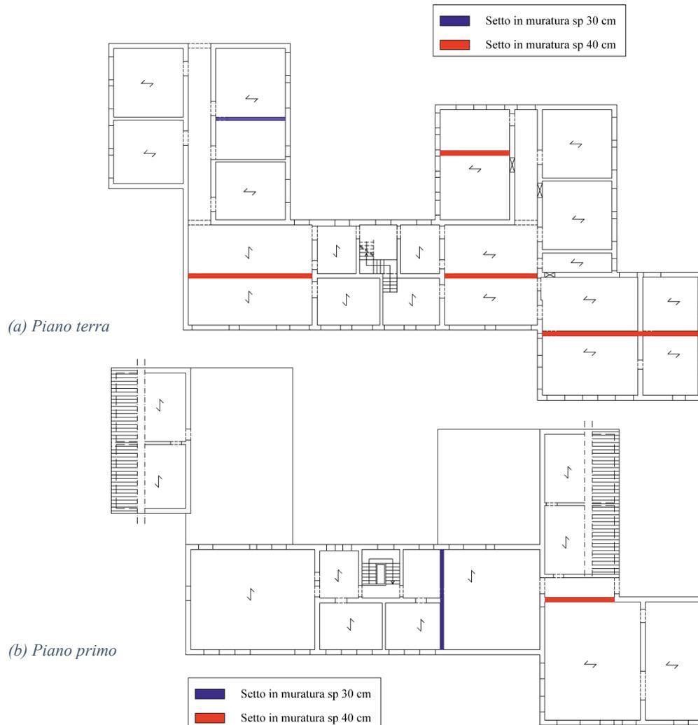
Figura 6-1: disposizione nuovi setti in muratura
