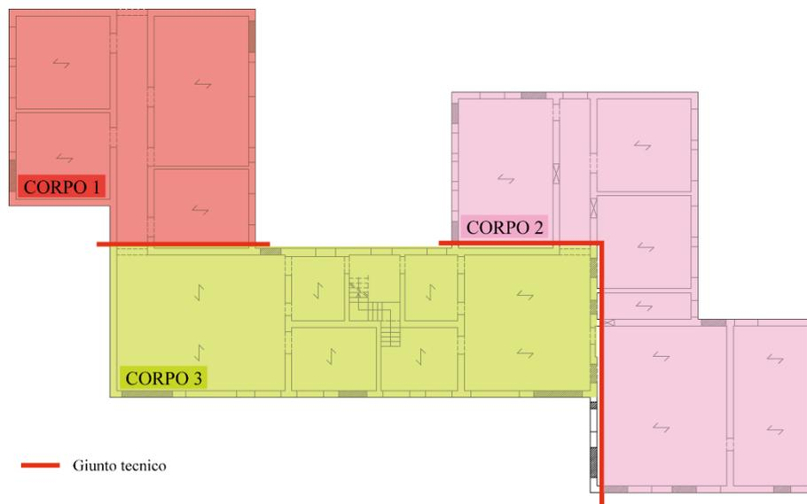
Figura 6-5: indicazione giunti tecnici
