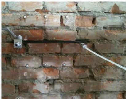
Fig. 71 – Esempio prova martinetto piatto singolo. FONTE: Mennuti & Co. Ingegneri
