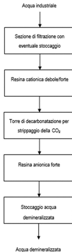
Figura 10 Schema di processo per la produzione di acqua demineralizzata
