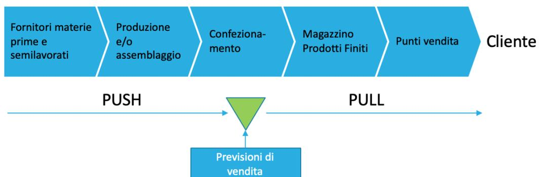
Figura 1 - Ogni *supply chain* (prodotto/mercato) richiede un diverso setup della *supply chain*, spostando più o meno a valle il punto di transizione tra *Make-to-Forecast* (*Push*) e *Make-to-Order* (*Pull*)
