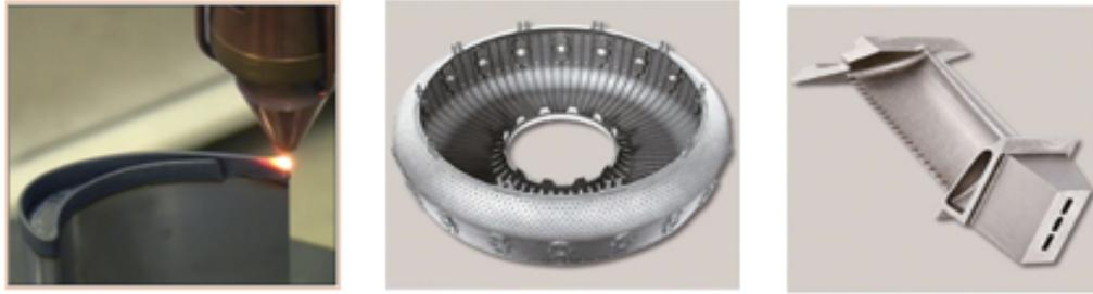
Figura 6- Ricostruzione di una paletta [2] / Combustore [11] / Paletta con canali conformali per la refrigerazione [11]
