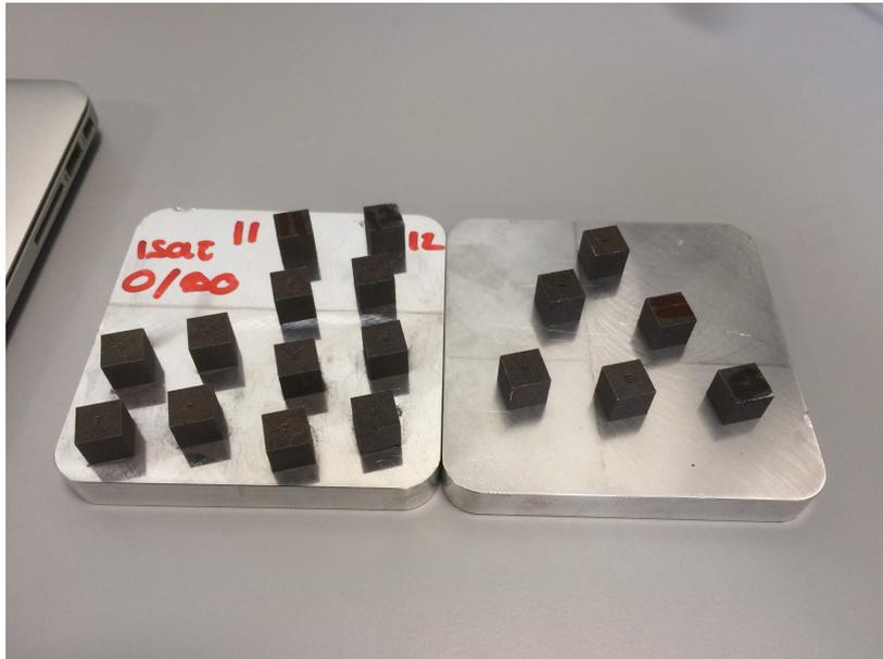
Figura 37-Campioni del JOB 2 ancorati alla piattaforma di costruzione
