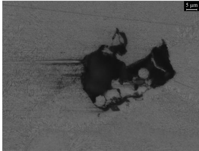
Figura 79-Porosità da ritiro/ mancata fusione di polveri (Campione n° 5 JOB 2)
