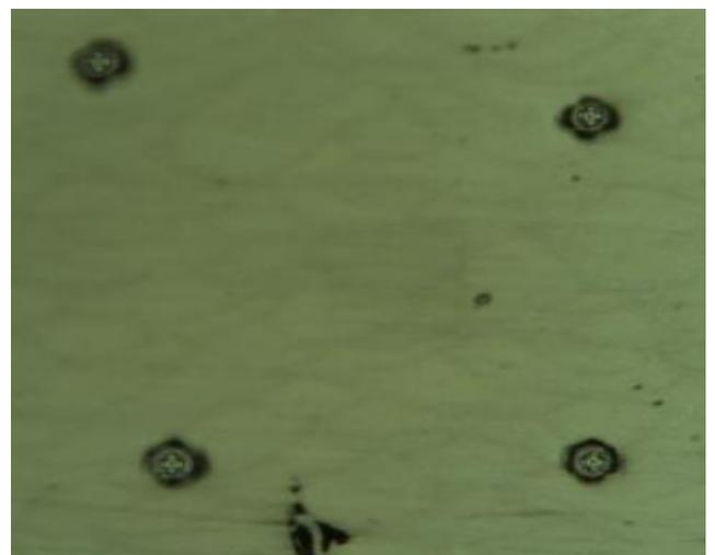
Figura 65-Mappa di nanodurezza campione n°8 JOB 1 /Immagine della zona di misurazione campione n°8 JOB 1
