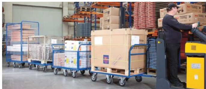
Figura 3.4 Tugger Train con carrelli [41]
