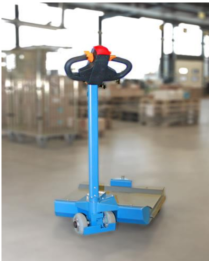
Figura 3.3: Motrice del Tugger Train [40]
