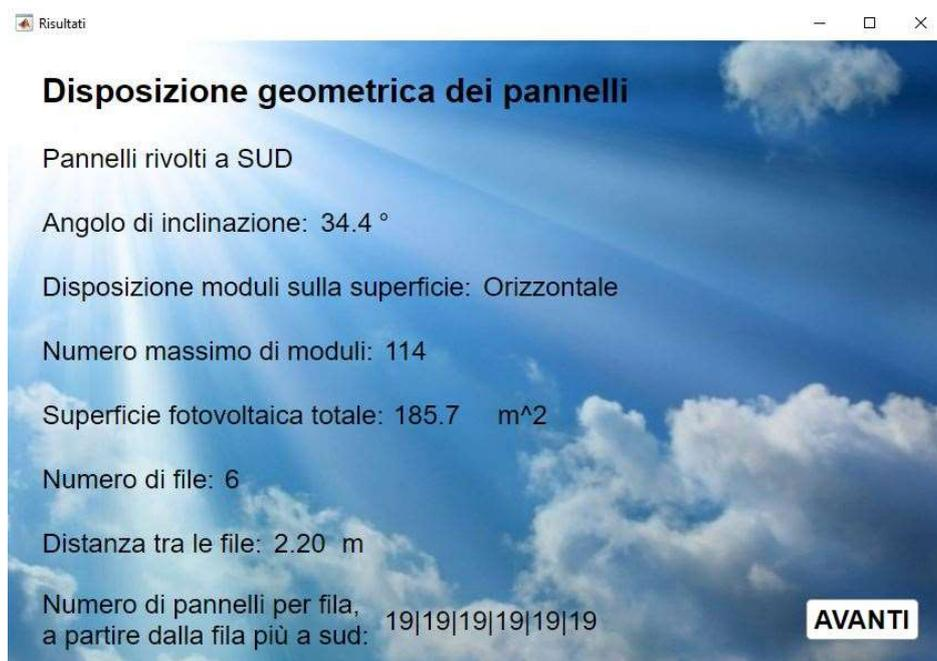
Figura 20. Output dimensionamento geometrico pannelli
