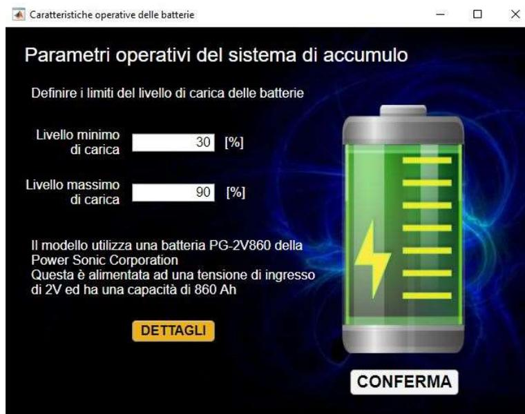
Figura 28. Finestra di selezione SOC minimo e massimo
