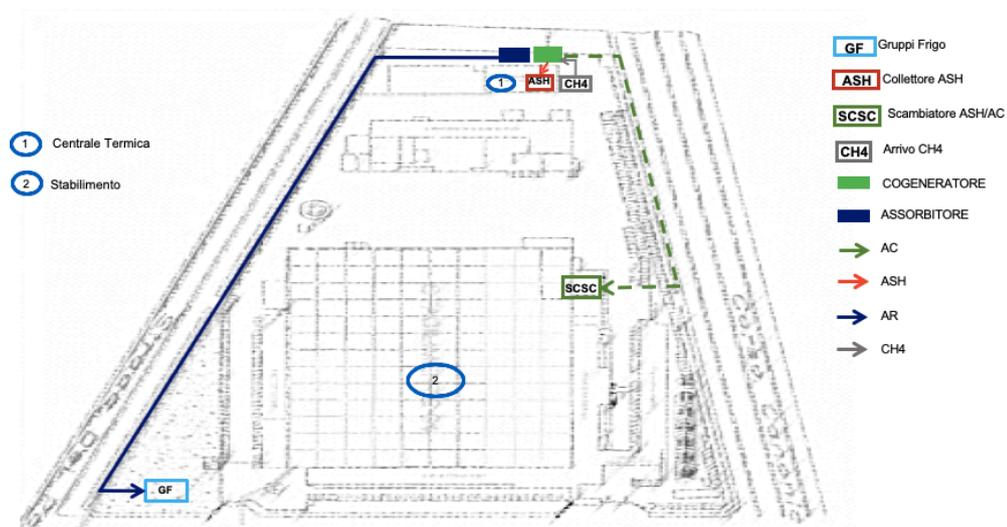
Figura 43 - Schema del posizionamento di cogeneratore ed assorbitore presso il Grugliasco
