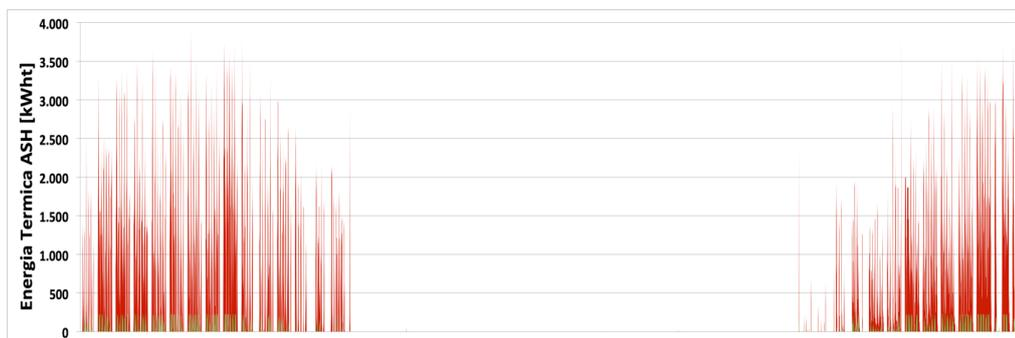
Figura 40 – Quota di energia termica sotto forma di acqua surriscaldata fornita dall'impianto di trigenerazione (in verde) sulla richiesta totale da parte dell'utenza (in rosso) – Grugliasco
