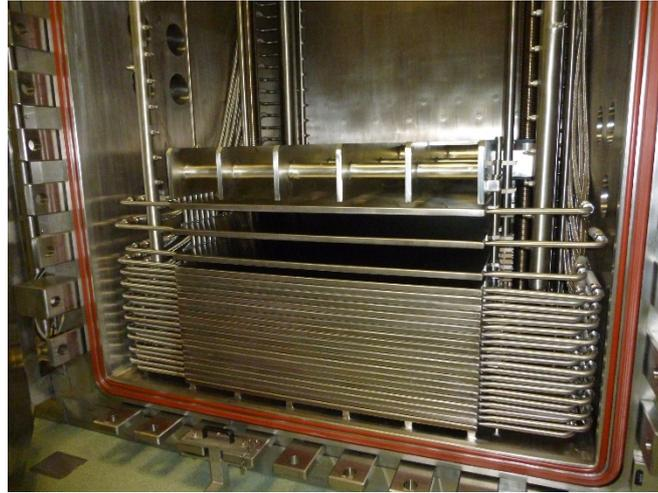
Figura 33: Ripiani del liofilizzatore
