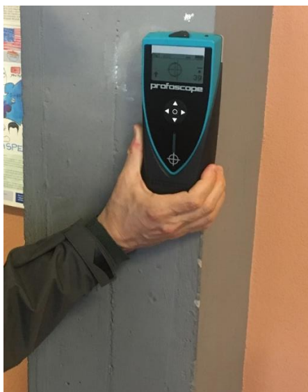
Figura 12. Utilizzo del pacometro sulla superficie in calcestruzzo di un pilastro
