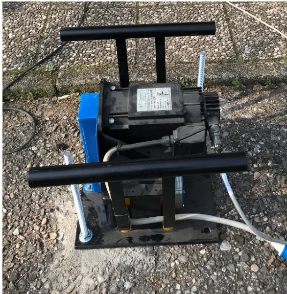
Figura 14. Vibrodina ad eccentrici con forza sinusoidale e unidirezionale
