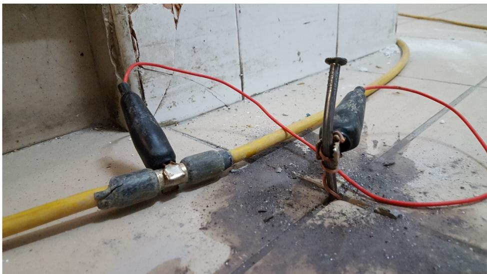
**Fig. 42: Foto dell'elettrodo utilizzato per l'ERT.**
