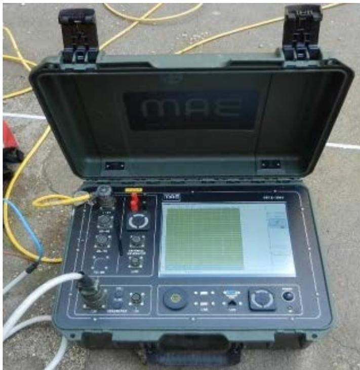
**Fig. 39: Georesistivimetro multielettrodico digitale (24 bit).**
