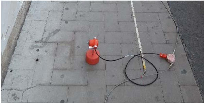
**Fig. 24: Geofono con frequenza propria di 4.5 Hz.**
