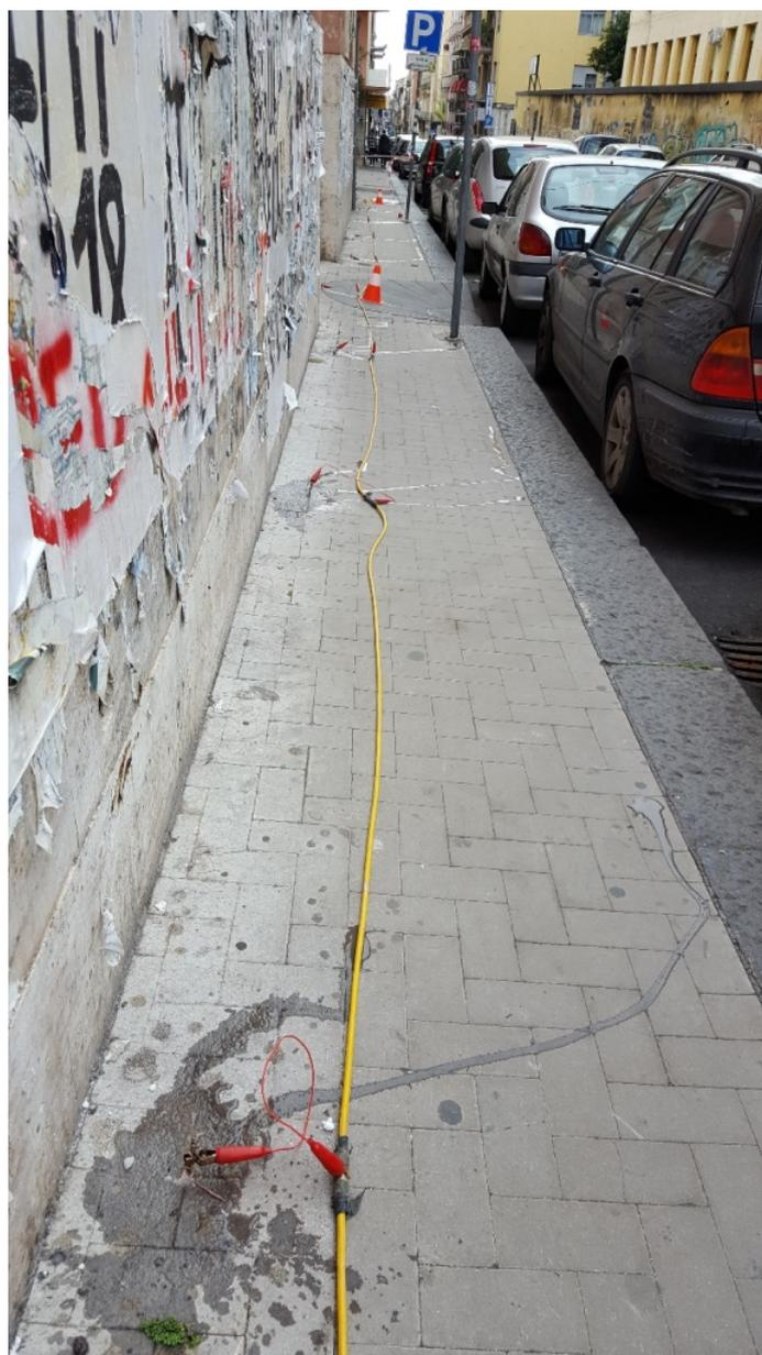
***Fig. 43: foto dell'ubicazione degli elettrodi per l'ERT2 eseguita lungo il perimetro esterno.***
