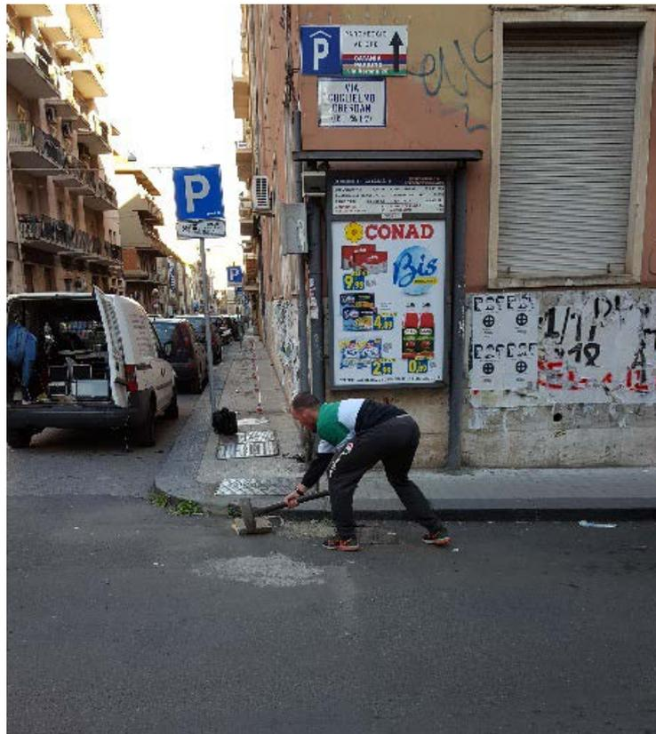
**Fig. 27: Foto della fase di energizzazione della prova MASW.**
