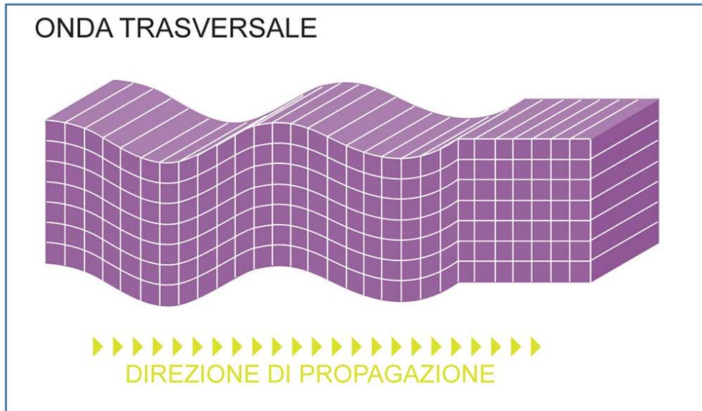
**Fig. 8: Schema di propagazione delle onde di volume di tipo S.**
