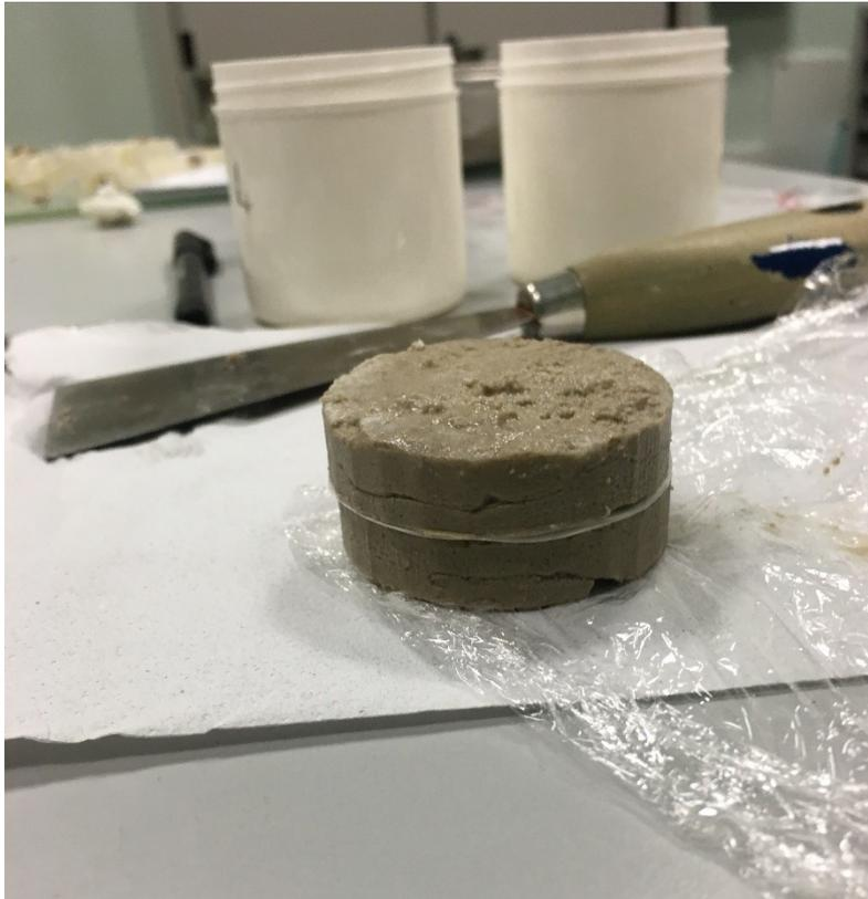
*Figura 66: Provini con carta filtro per la misura della suzione di matrice*
