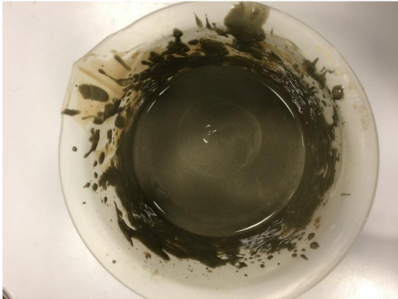
*Figura 40: Miscela di cemento e bentonite*
