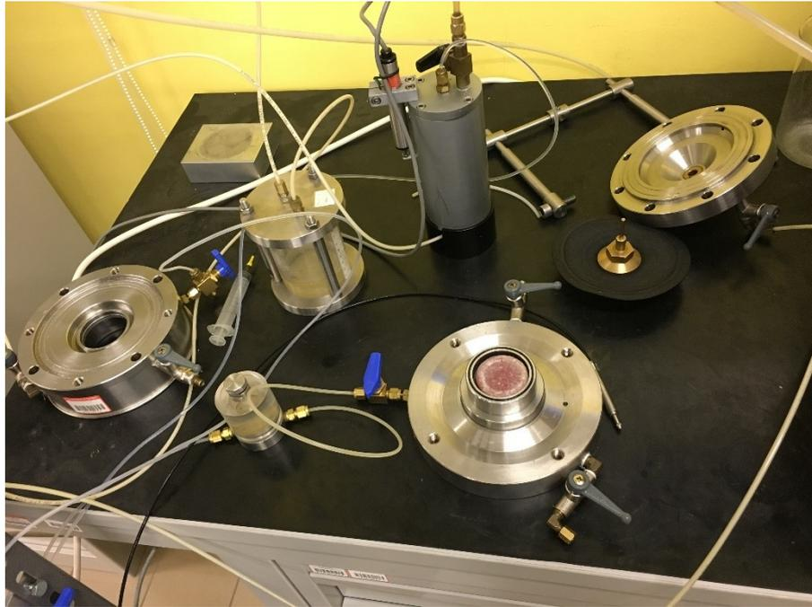
*Figura 36: Edometro a suzione controllata smontato*
