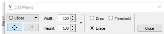
Fig. 1.5 – EditMask, in questo caso permette di cancellare i pixel, poiché è selezionata l’opzione “Erase”.
