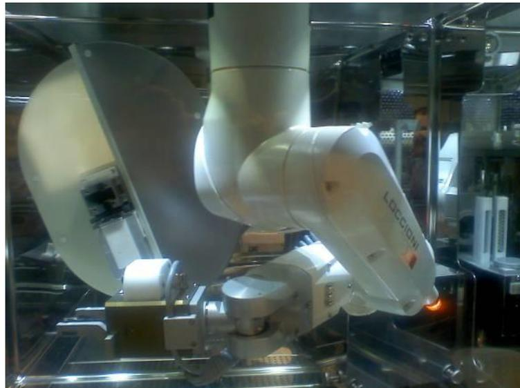
Figura 2.3 Robot antropomorfo equipaggiato con clamp, camera e sistema di afferraggio
