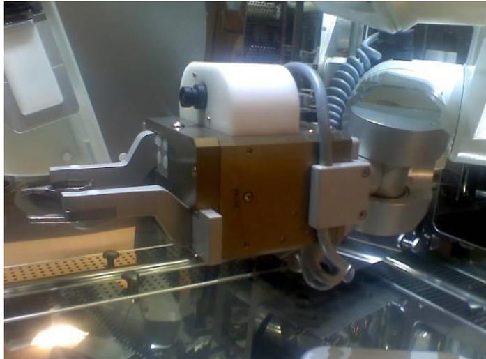
**Figura 2.4** Pinza elettrica e dispositivo di visione per la localizzazione dell'ago
