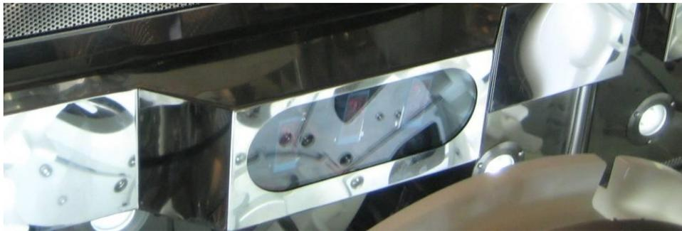
Figura 2.21 Sensori di presenza e di altezza per flaconi
