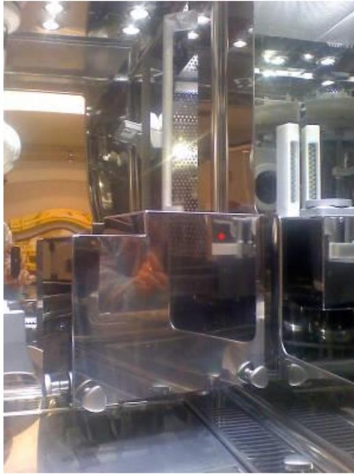
**Figura 2.8 Dispositivo di pesatura di precisione**
