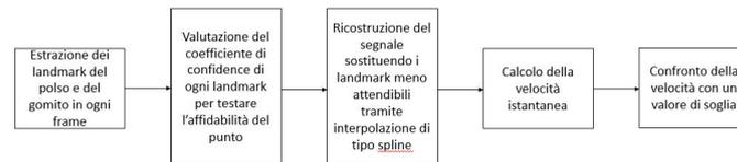
Figura 2.13: Schema a blocchi del parametro “agitare le braccia”
