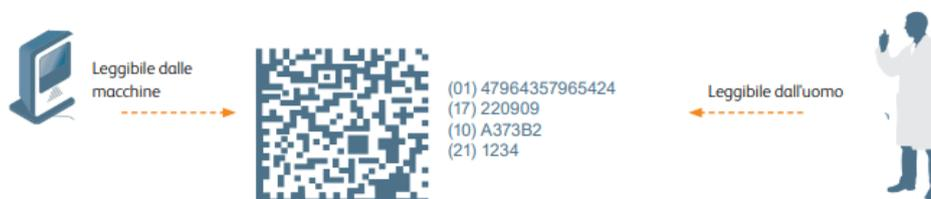
(b) Esempio di un codice a barre GS1-DataMatrix comunemente utilizzato per la conformità all'UDI.
