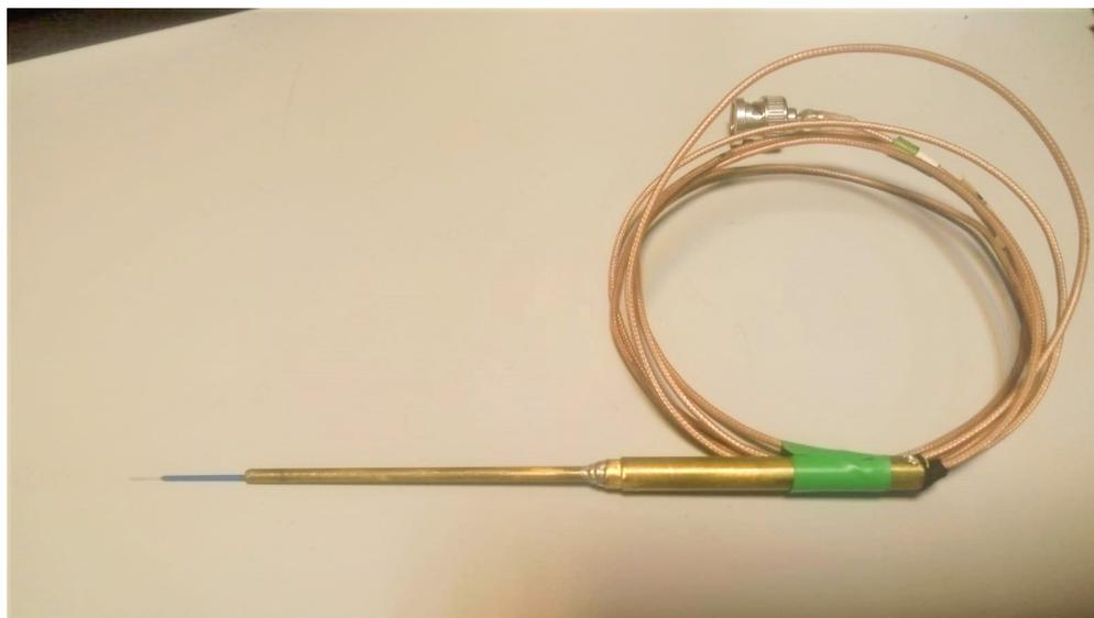
**Figura 4.2:** Fibra ottica e fotodiode incapsulato
