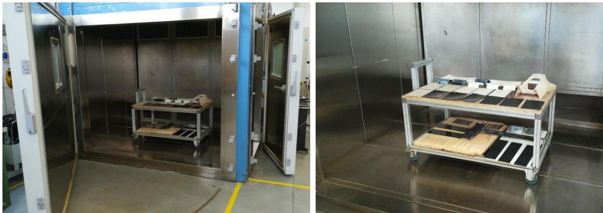
**Figura 3.18:** Collocamento dei particolari all'interno della cella climatica.
