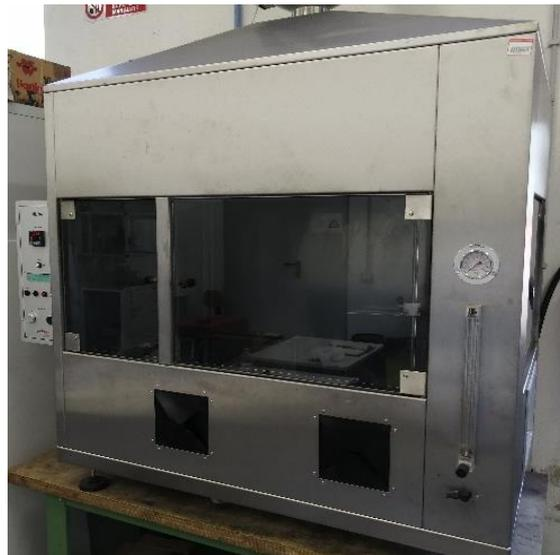
**Figura 3.16:** Camera standard all'interno della quale sono state svolte le prove UL-94.
