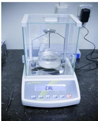
**Figura 3.7:** Bilancia di Archimede utilizzata per la valutazione della densità.
