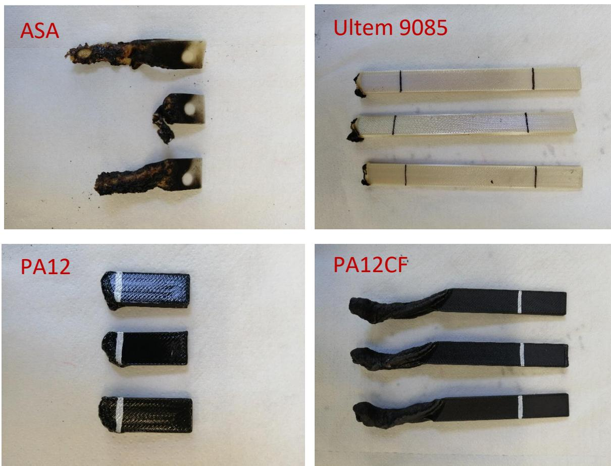
Figura 4.32: Residui di materiale a seguito del test UL-94.
