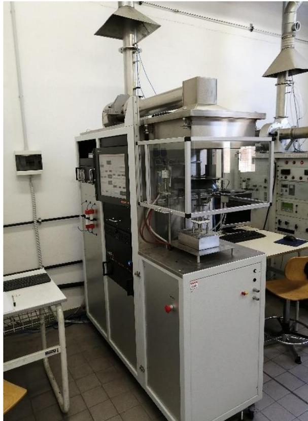
**Figura 3.17:** Cono calorimetro usato per l'esecuzione dei test.
