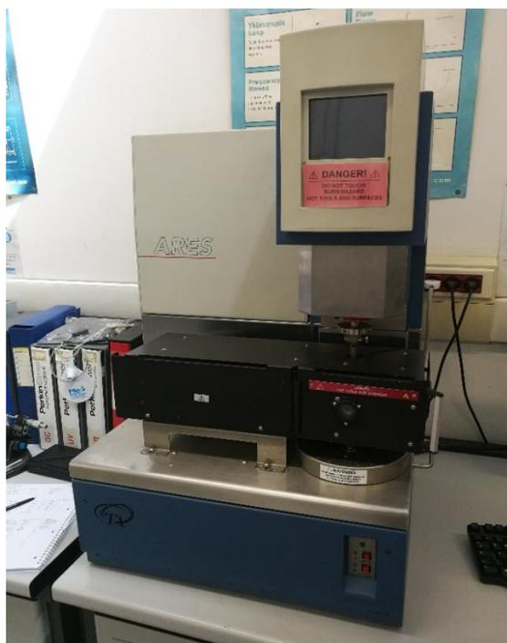
Figura 26 – Reometro Ares, utilizzato per le prove reologiche.
