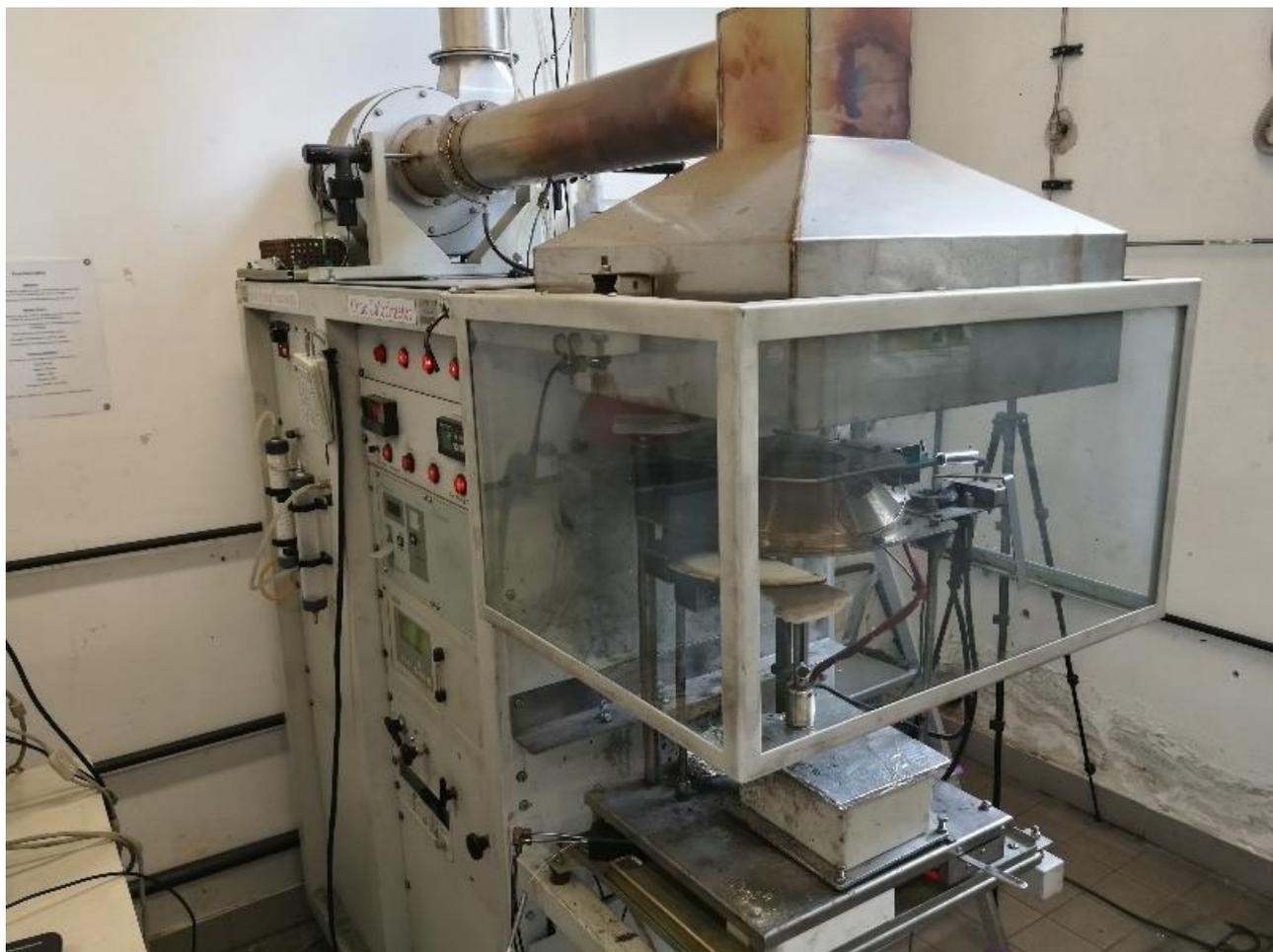
Figura 35 – Cono calorimetrico.
