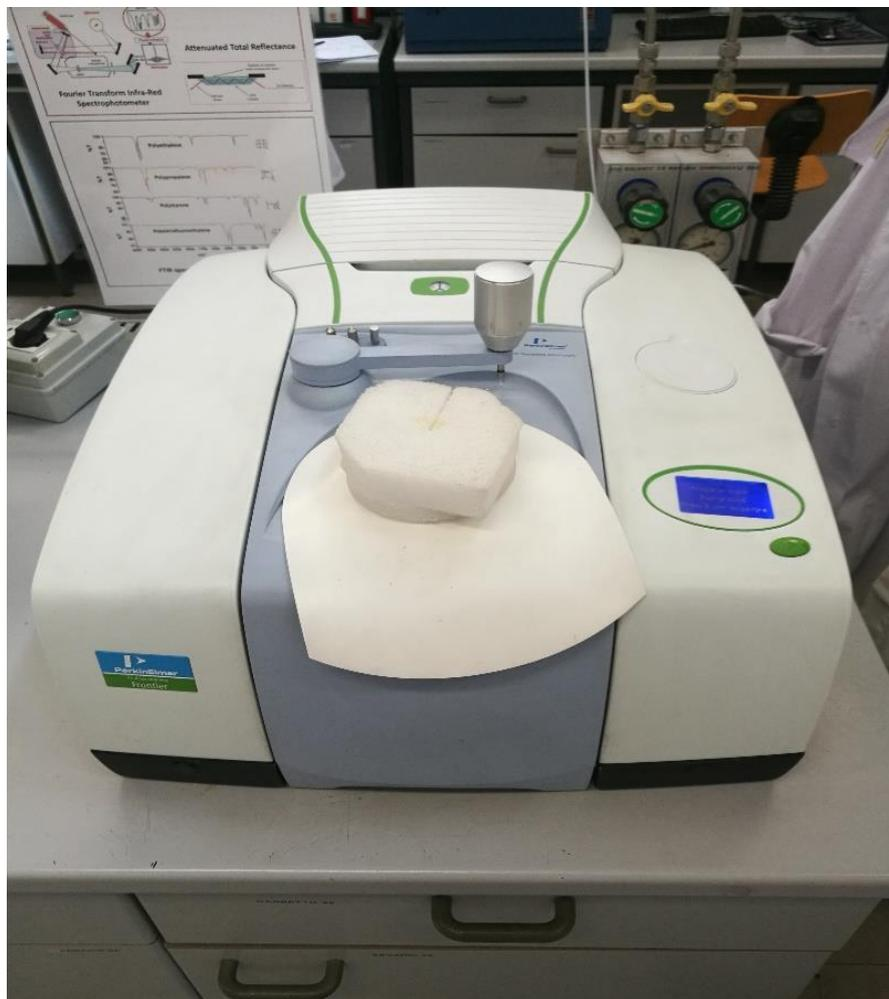
*Figura 32 - Frontier Spectrofotometer utilizzato per l'analisi della carica inorganica*
