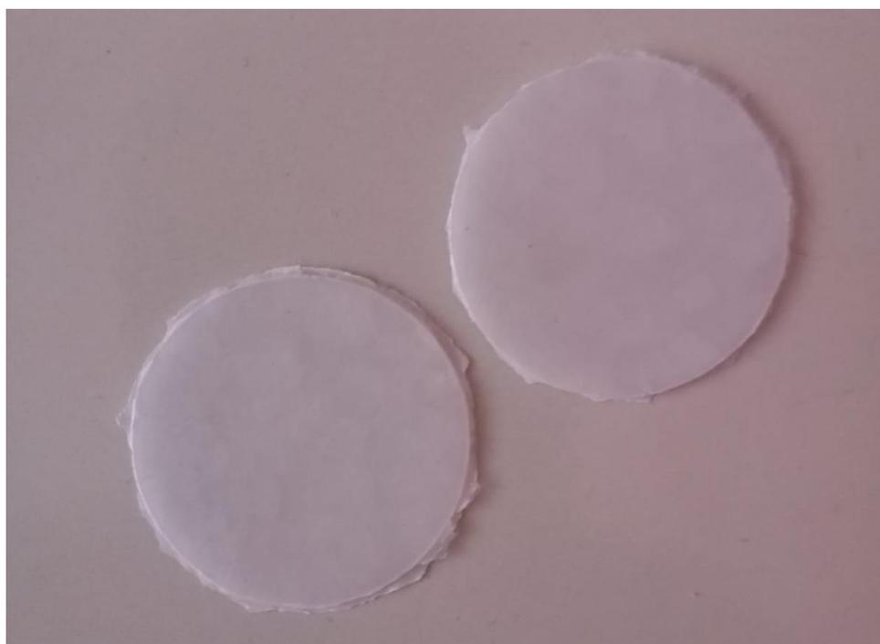
*Figura 56 – Provini utilizzati per l'analisi reologica.*
