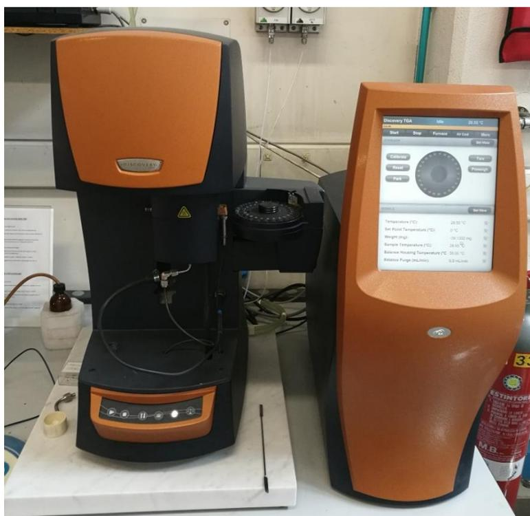
Figura 29 – TGA discovery, macchinario utilizzato per le analisi TGA.
