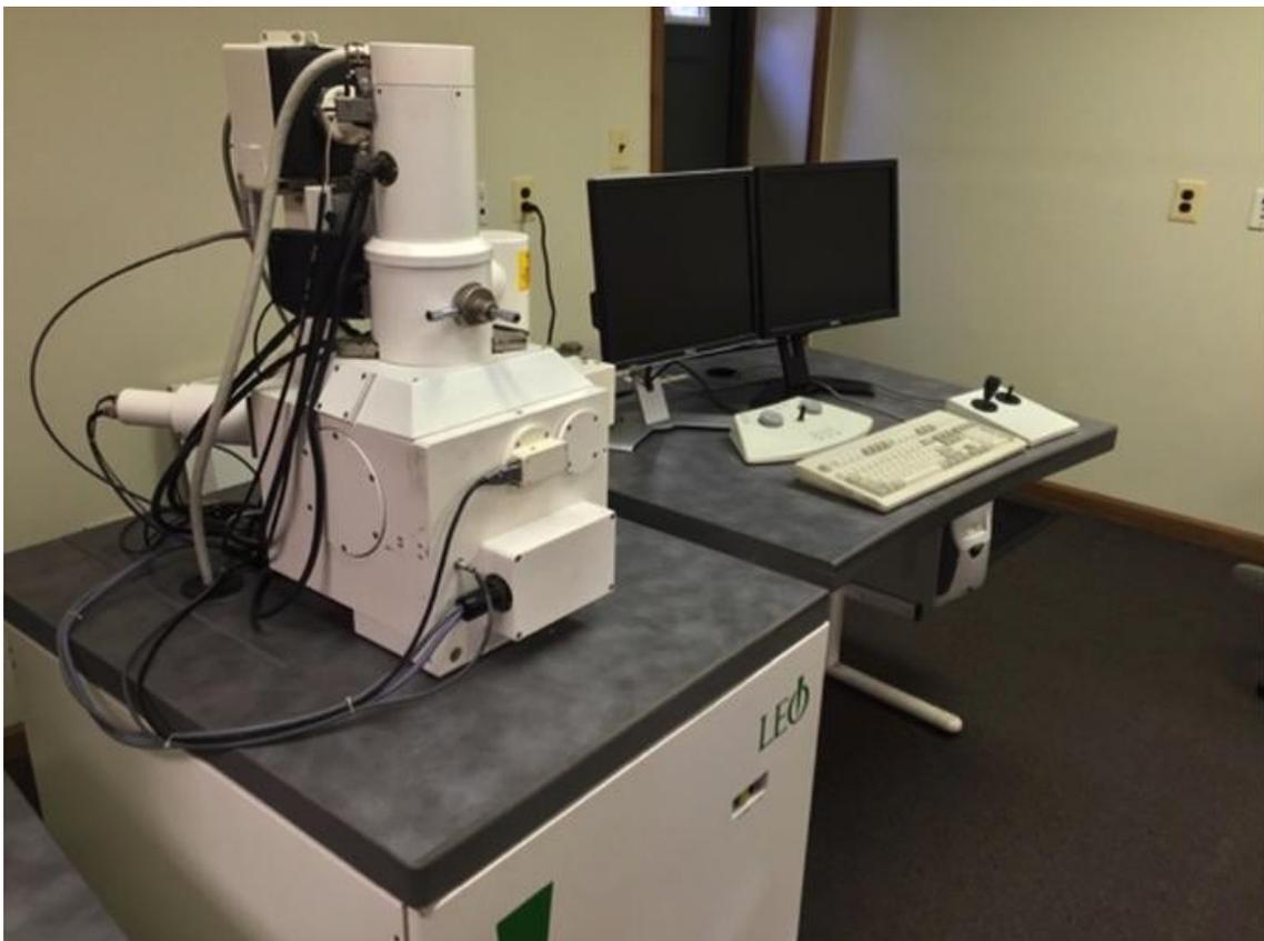
Figura 39 – SEM LEO-1450VP, prodotto da Zeiss.
