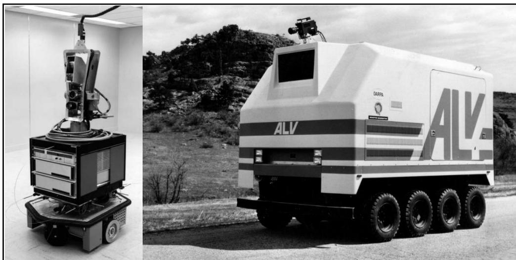
Fig. 1.3 – prototipo dello Shankey a sinistra e dell'ALV a destra
