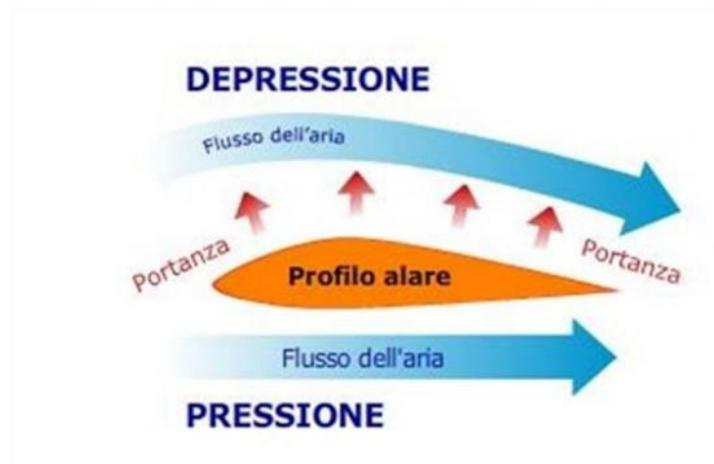
Figura. 2.3. Profilo investito da flusso d'aria. Generazione di portanza [5]
