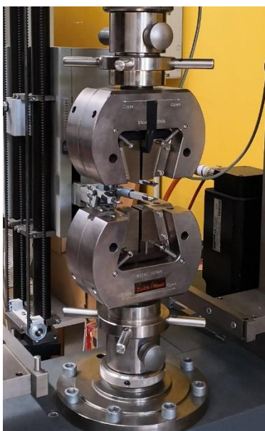
Figura 38: sistema di afferraggio e trasduttore per trazione
