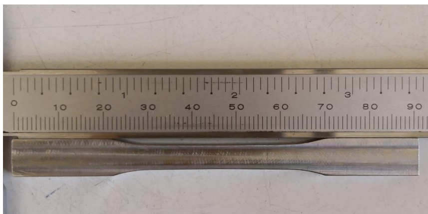
Figura 29: campione per analisi di trazione conforme alla normativa ASTM E8/E8M – 16a
