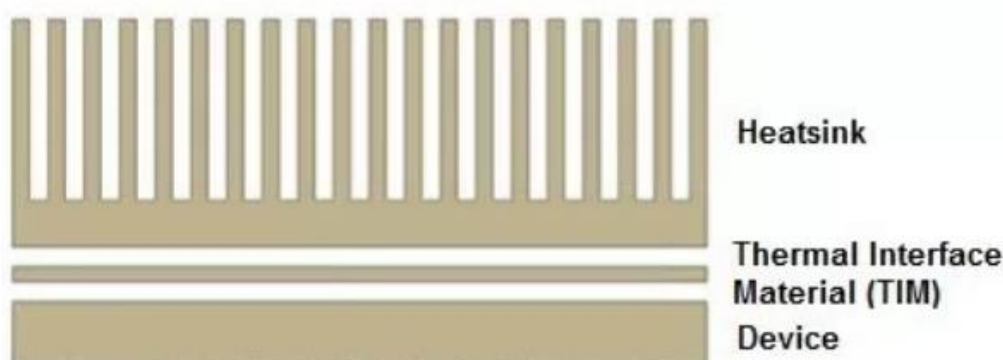
Figura 9 - Schema di un sistema per la dissipazione del calore di un device elettronico
