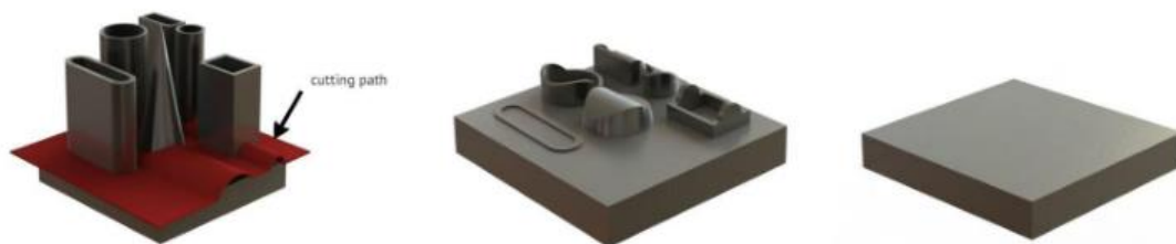
Figura 51 - Fasi del processo di rimozione del pezzo finito dalla piattaforma di costruzione
