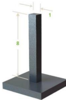
Figura 64 - Mantenimento del rapporto 1:8 tra lato corto base ed altezza di strutture snelle
