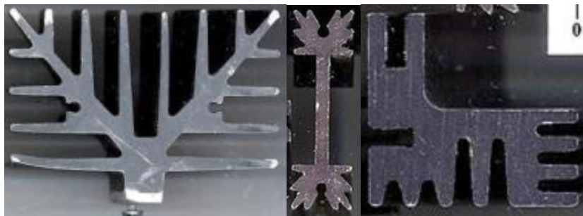
Figura 25 - Geometrie di heatsink ottenuti con ottimizzazione topologica 2D
