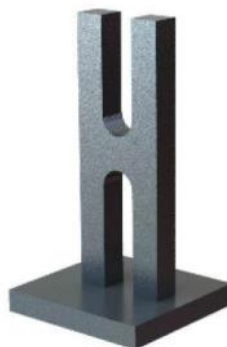
Figura 66 - Esempio di soluzione dell'inflessione attraverso l'aggiunta di strutture che aumentano la rigidità del pezzo
