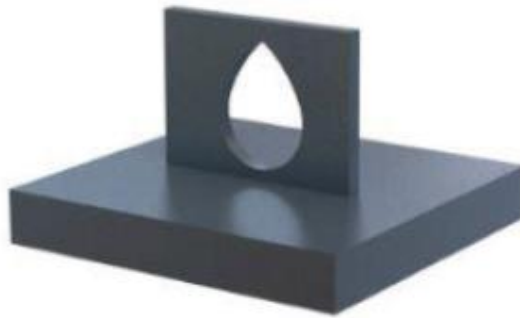
Figura 53 - Esempio di modifica di geometria del foro per evitare il bisogno dei supporti
