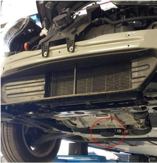
*FIGURA 16: vista frontale del veicolo. È possibile notare la presenza del condotto di scarico dell'aria dal motore.*
