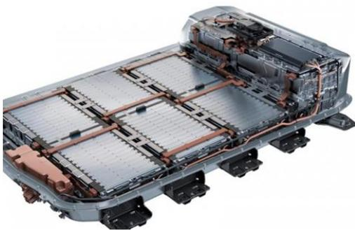
FIGURA 9: Pacco batteria Renault Zoe.
