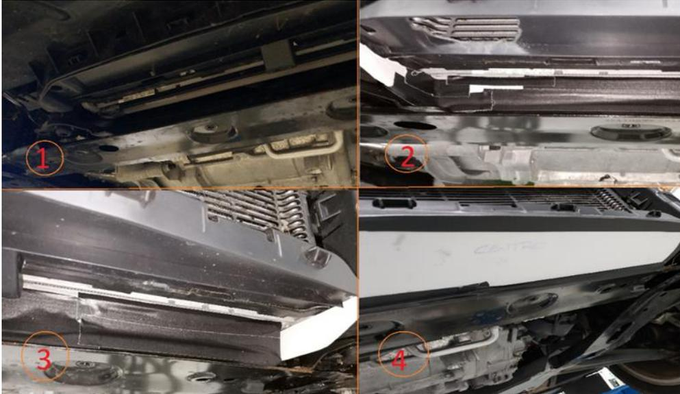
FIGURA 32: sequenza di immagini che illustrano i passaggi per la costruzione del convogliatore sotto il veicolo, in prossimità del condensatore: 1. Vista dal basso del veicolo in cui è presente il cooling module; 2. Costruzione delle pareti del convogliatore nel lato sinistro; 3. Costruzione delle pareti nel lato destro; 4. Struttura complessiva.
