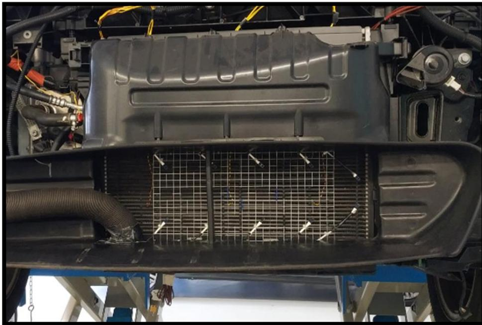
*FIGURA 46: anemometri disposti di fronte al veicolo per la misura del flusso di aria che entra nel cooling module.*
