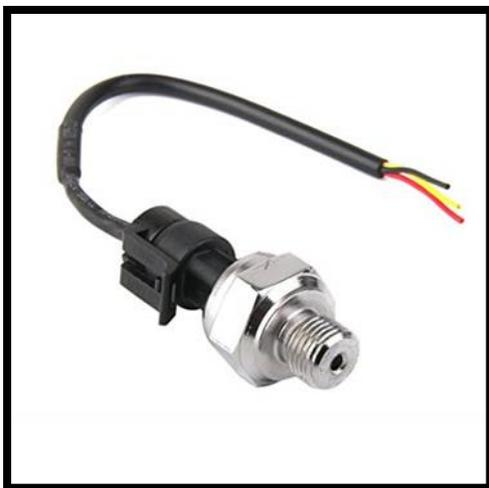
La pressione applicata al trasduttore di pressione produce una flessione del diaframma che a sua volta porta alla deformazione degli estensimetri. La deformazione produrrà un cambiamento della resistenza elettrica proporzionale alla pressione stessa.
