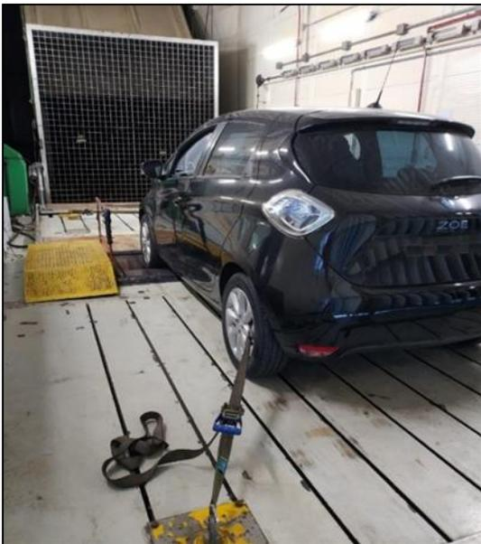
FIGURA 47: Veicolo montato in galleria climatica durante le prove.
