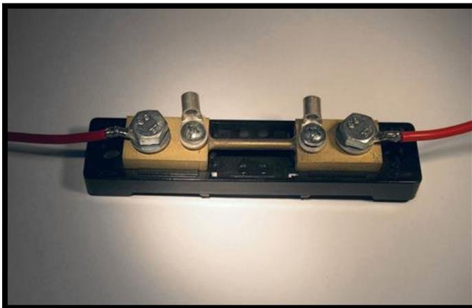
principale a cui è posto in parallelo. L'entità della corrente deviata dipende dal valore resistivo dello shunt rispetto al circuito in parallelo.
