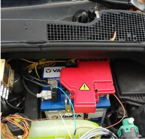
*FIGURA 11: batteria di bassa tensione utilizzata per alimentare gli organi ausiliari del veicolo che necessitano, per il loro funzionamento, di una tensione bassa.*
