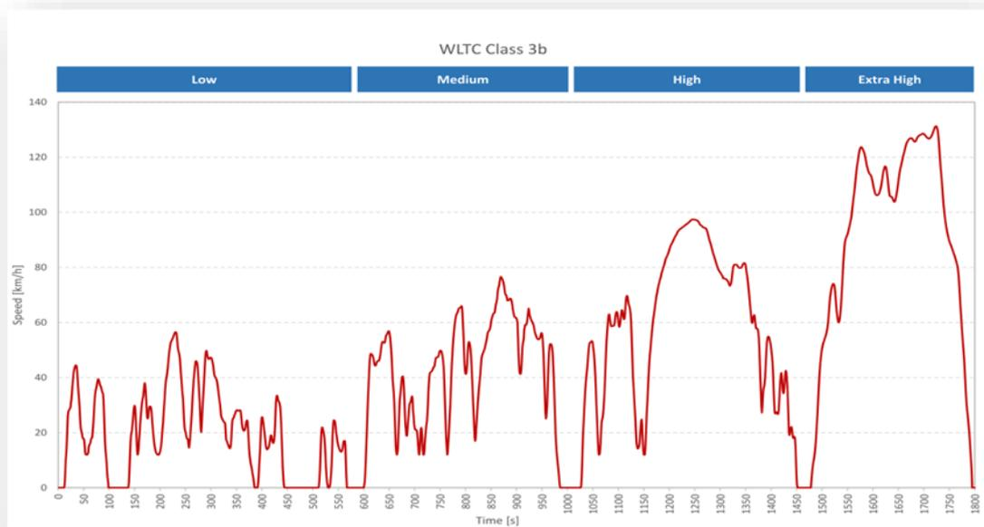
FIGURA 61: ciclo guida WLTP usato per le seconde prove.
