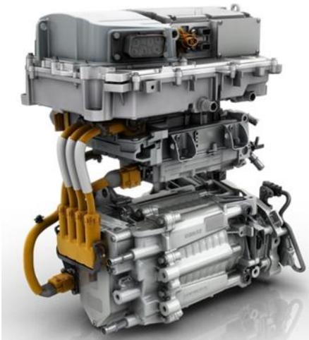
Tale motore ha una potenza di 65kW (88cv) ed eroga una coppia massima di 220 Nm, ad un regime che va da 290 a 2500rpm, mentre il regime di massima potenza va invece dai 3000rpm in su. Il consumo della vettura con un motore Q 90 è di 146 kWh con un'autonomia su un ciclo NEDC di 368 km.
