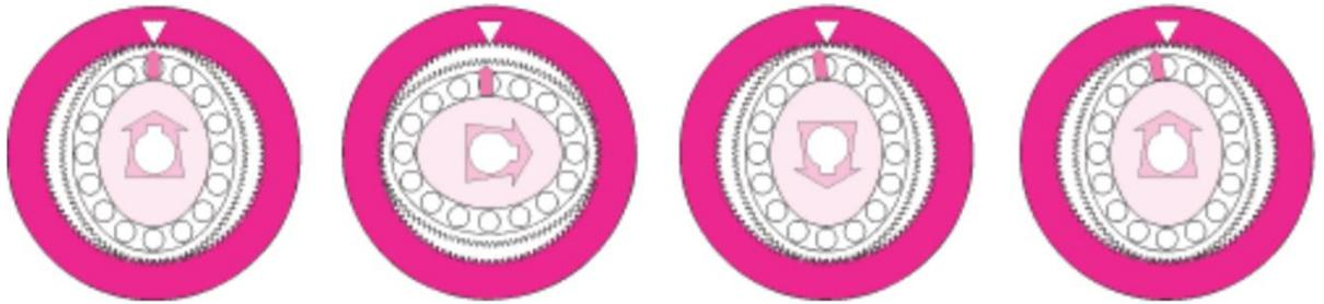
Figura 36 Principio di funzionamento di un Harmonic Drive [23]
